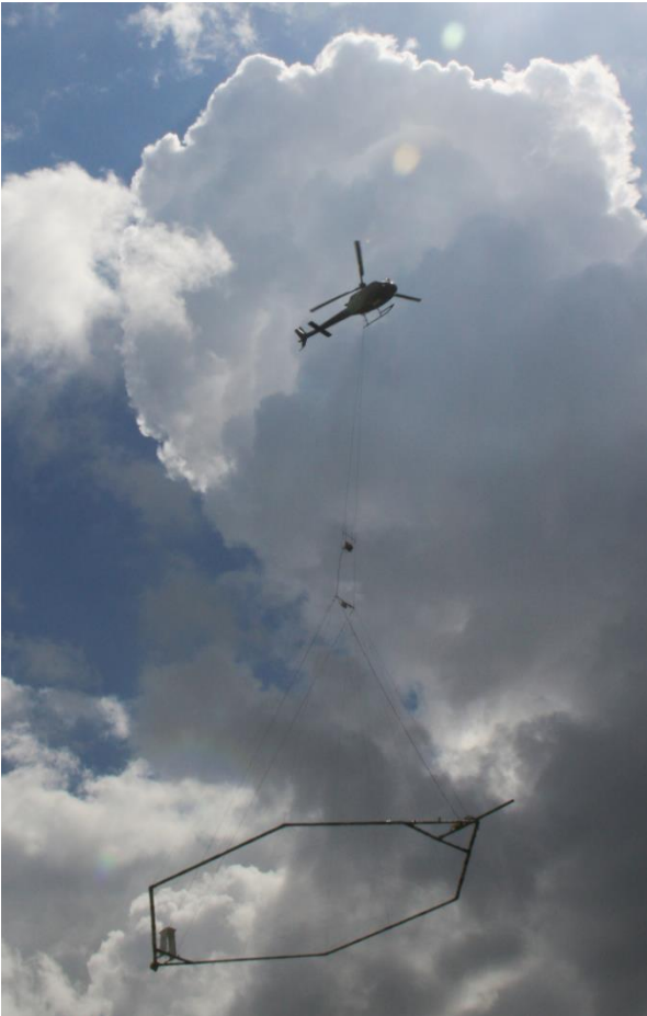
Figuur 5.1 Helikopter en meetframe boven Oostende-Brugge Airport.
