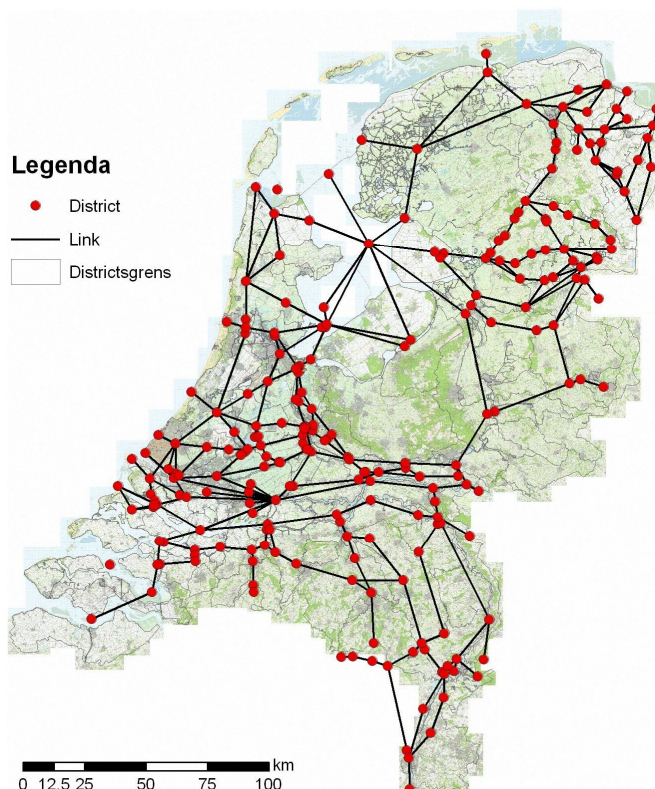
Figuur 2.1 Schematisatie van het hoofdwatersysteem in het Distributiemodel
