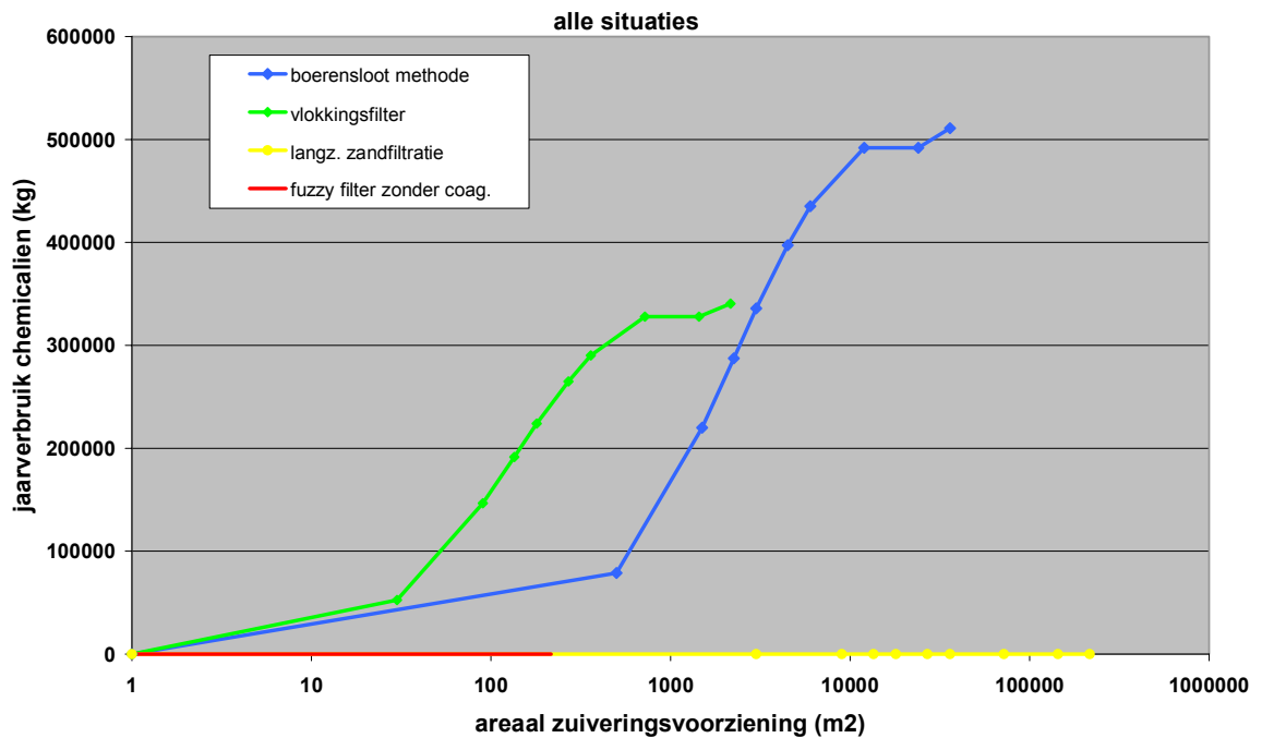
Figuur B1. Chemicaliënverbruik op jaarbasis, alle voorbeeldpoldertypen, gemaal- en recirculatie.
