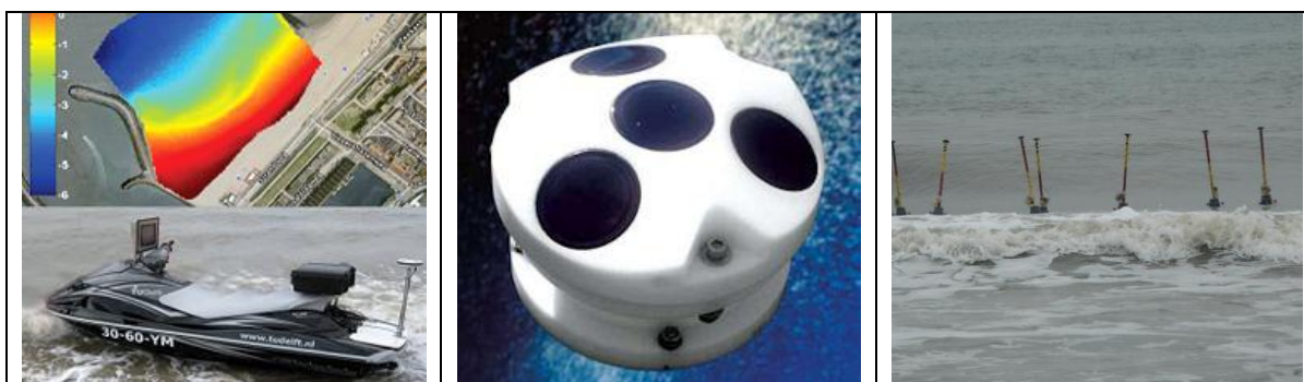
Figuur 5-1. Jetski met RTK GPS en single-beam echosounder (links), Nortek AWAC (midden) en GPS drifters (rechts)
