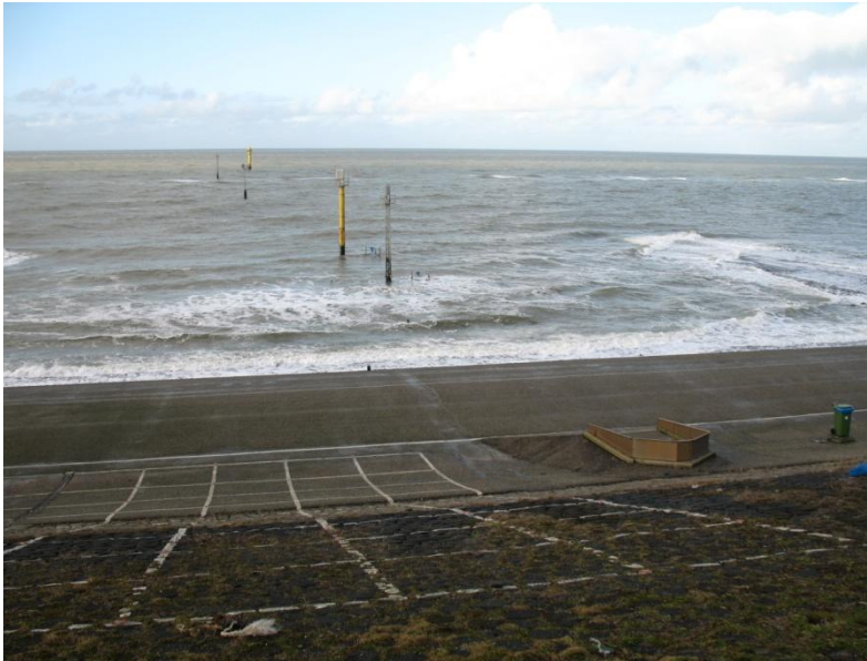
Figuur 7.2 Opstelling golfploopmetingen Pettemer Zeewering
