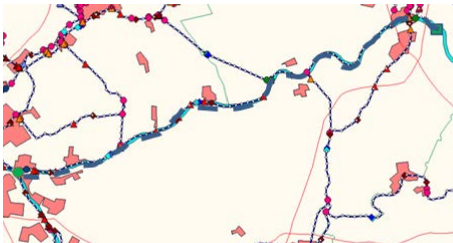
Figuur C.2 Overlap riviertak voor RWSW en Rijntakkenmodel op de Lek. Er is overlap tussen Hagestein (vierhoekig punt) en de ronde punten bij Krimpen a/d Lek.
