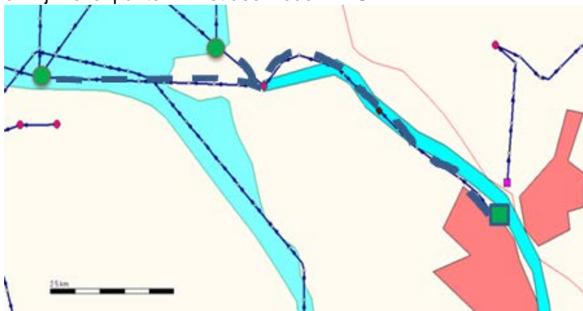
Figuur C.1 Overlap tussen RWSW en Rijntakkenmodel bij Kampen; overlap zit tussen het vierhoekige punt (Kampen) en de ronde punten (Keteldiep/Kattendiep).
