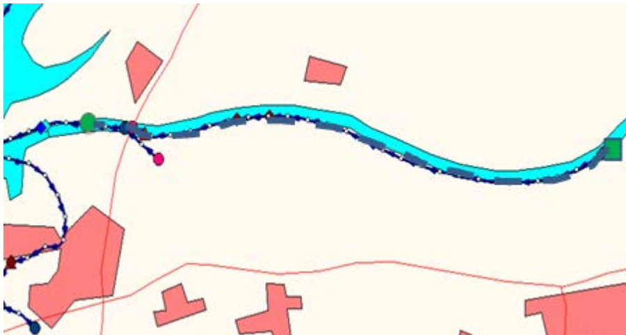
Figuur C.4 Overlap voor het deelmodel Maas. Er is overlap tussen Keizersveer (rond punt) en de bovenstroomse RWSW rand (vierhoekig punt)
