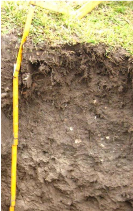
Figuur A.13 Middelste inspectiekuil: Steen in de ter plaatse zeer zachte keileemlaag
