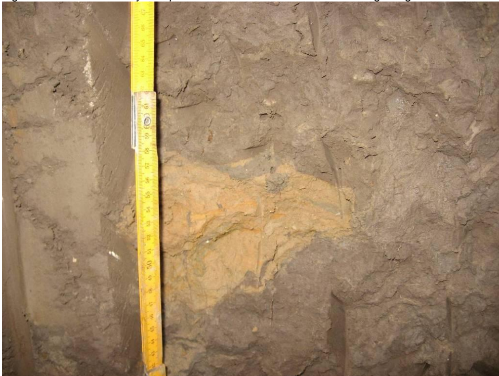
Figuur A.10 Westelijke inspectiekuil: Detail van roodbruine insluiting in Figuur A.9
