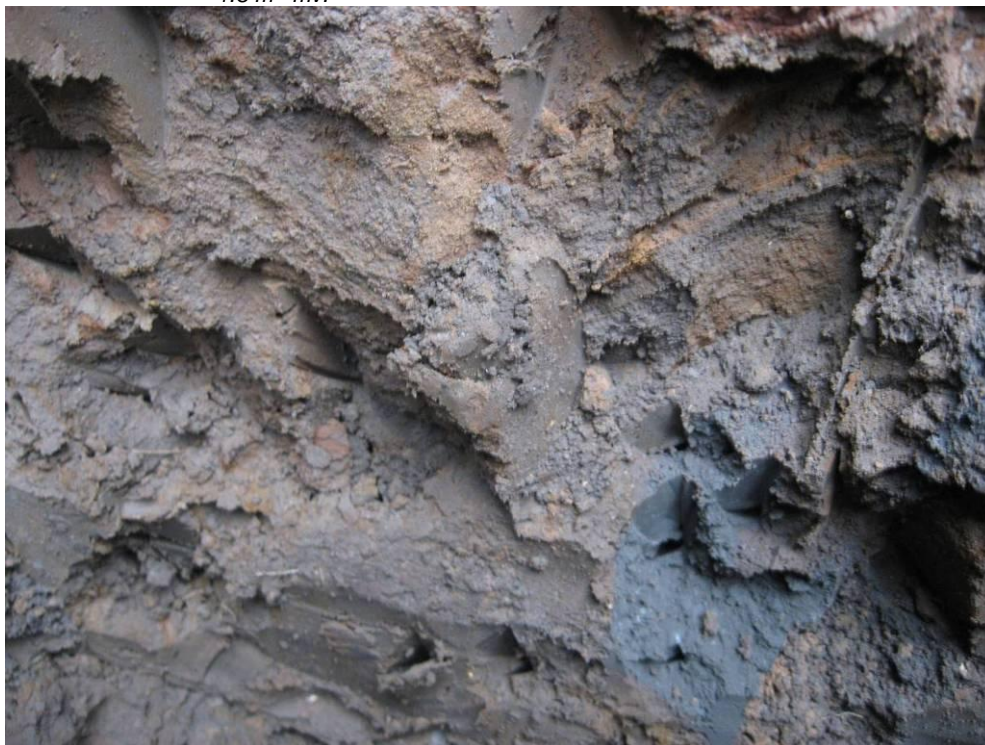
Figuur A.6 Oostelijke inspectiekuil: Detail van de zachte en de "taaije" keileembrokken (aanbrengen) op 1.6 – 1.8 m –mv.
