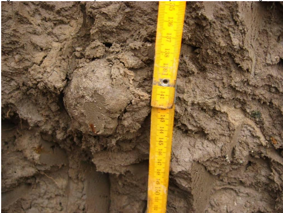
Figuur A.13 Middelste inspectiekuil: Steen in de ter plaatse zeer zachte keileemlaag
