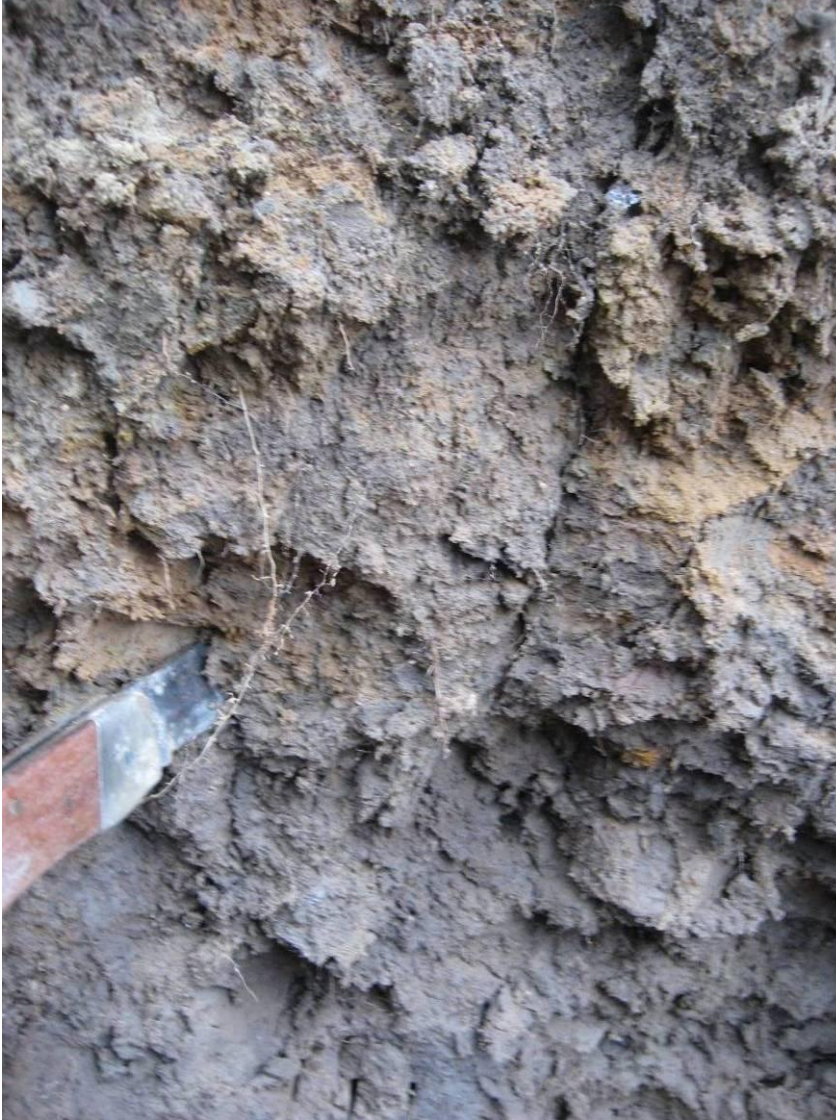
Figuur A.8 Westelijke inspectiekuil: Keileem op 0.35 m – mv. met wortels en een spleet van de grof prismatische structuur.
