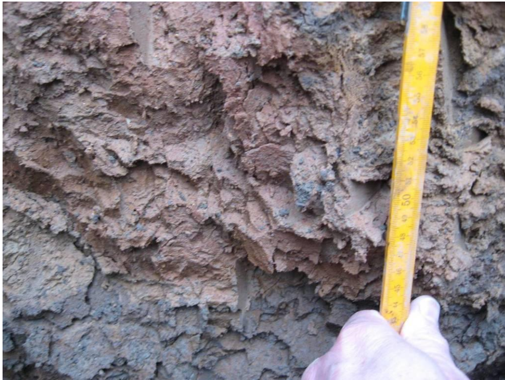
Figuur A.5 Detail van de bovenkant van de blokkige zone in Figuur A.4. De gelamineerdheid wordt ook in situ keileem herkend.
