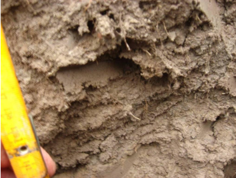
Figuur 0.3 Oostelijke inspectiekuil: Zand inschakeling in de keileem.
