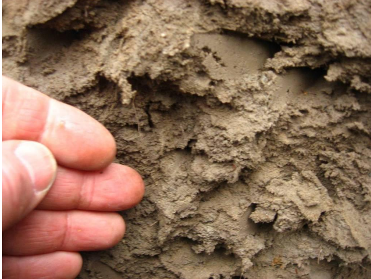
Figuur 0.14 Middelste inspectiekuil: Zandige insluiting in de ter plaatse zachte keileem. Wortels komen tot juist boven de overgang naar het onderliggende zand voor.
