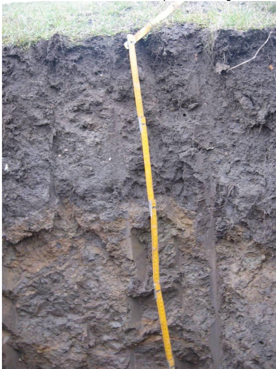
Figuur 0.2 Overzicht van de oostelijke inspectiekuil. De overgang van k lei naar keileem op ongeveer 0.4 m is door de ter plaatse rossige tint van de keileem goed te zien.
