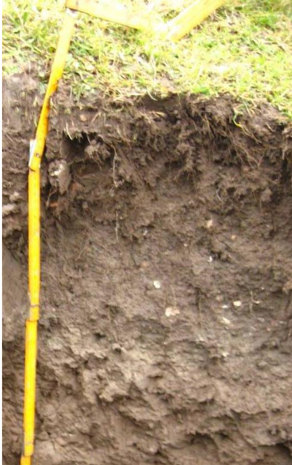
Figuur 0.12 Middelste inspectiekuil: De kleilaag bevat veel schelpmateriaal ter plaatse en de zodelaag is dicht doorworteld. De lichtere laag onder de zone met schelpen is de top van de keileemlaag.
