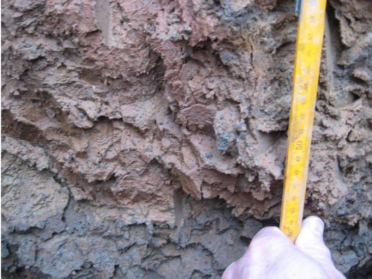
Figuur 0.5 Detail van de bovenkant van de blokkige zone in Figuur 0.4. De gelamineerdheid wordt ook in situ keileem herkend.
