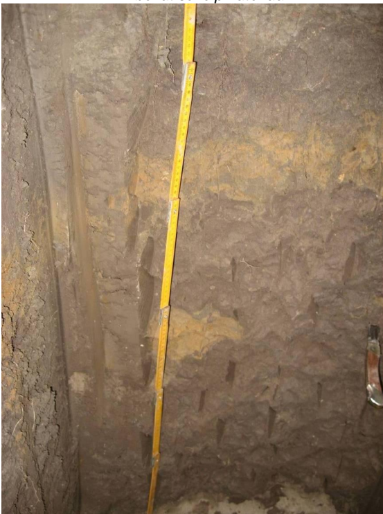
Figuur 0.9 Westelijke inspectiekuil: De keileemlaag bevat rood bruine keileeminsluitingen. De keileemlaag bevat schelpmateriaal.
