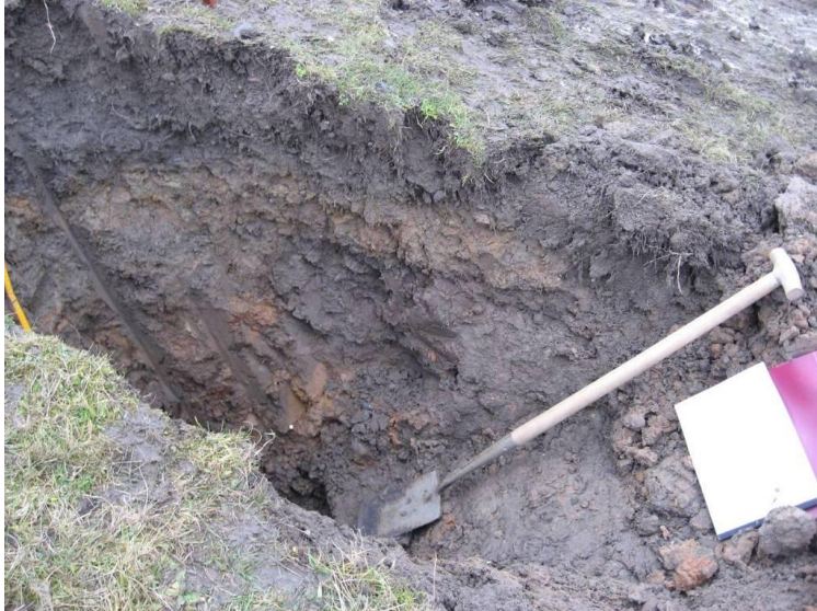
Figuur 0.7 Oostelijke inspectiekuil: Overzicht van kuil met de inschakeling van keileem met schelpmateriaal (bruingrijze laag onder helder grijsbruine laag in de foto) op ongeveer 0.4 m –mv.
