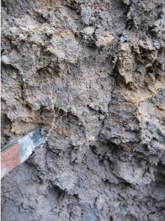
Figuur 0.8 Westelijke inspectiekuil: Keileem op 0.35 m – mv. met wortels en een spleet van de grof prismatische structuur.
