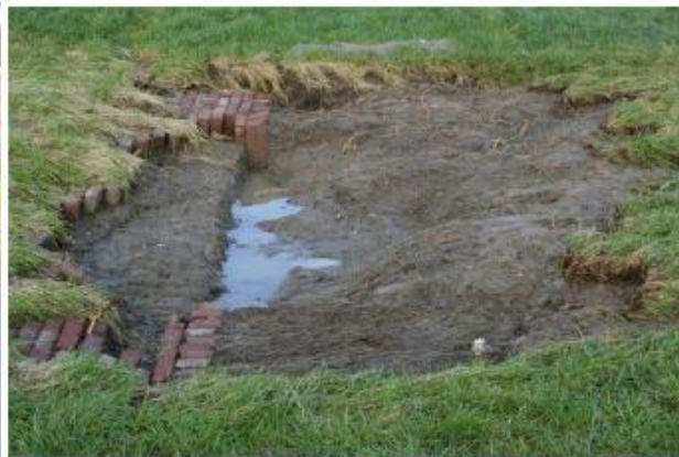
Figuur 4.1 Eindsituatie teststrook 1 (rechts overgang bij teen talud)
