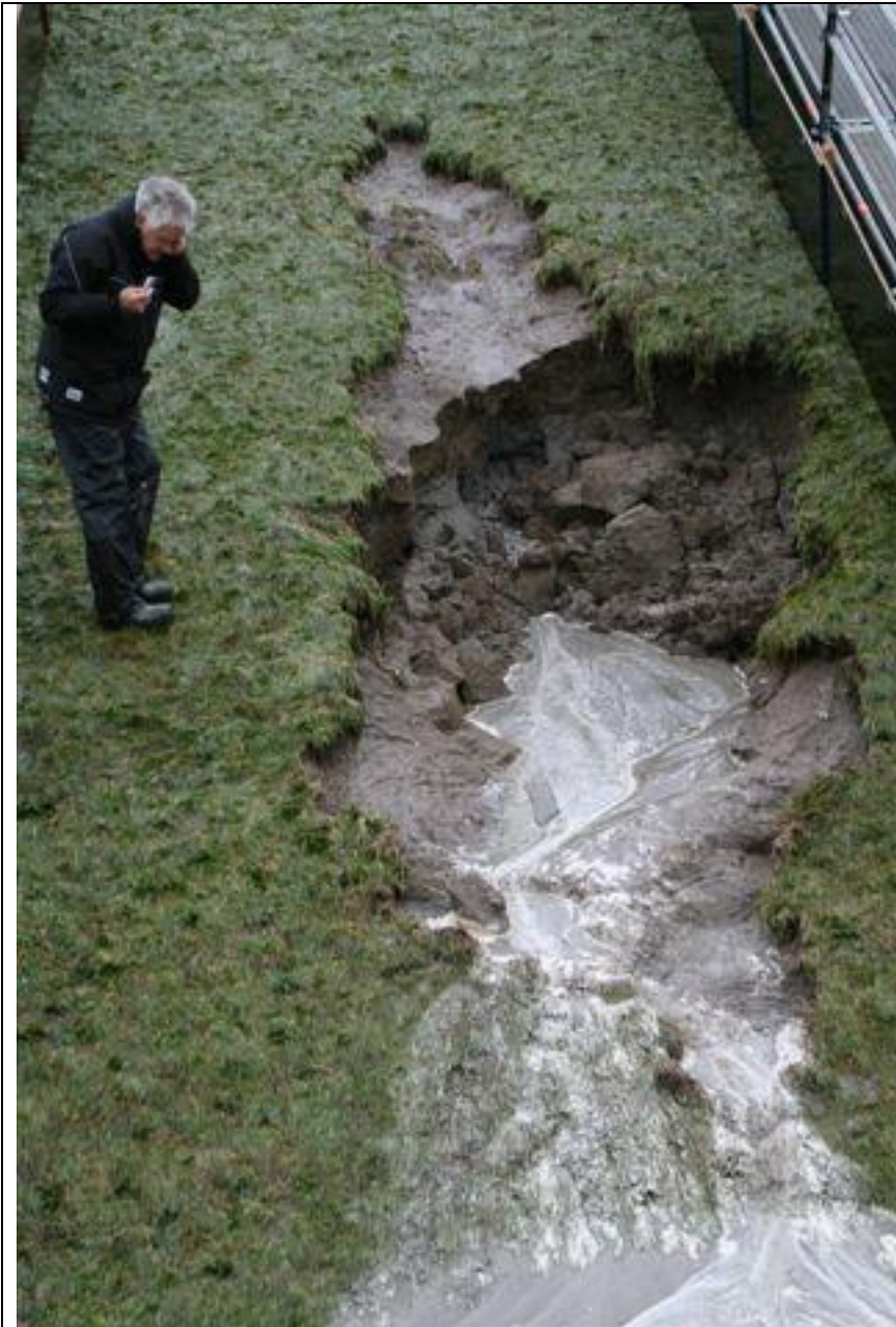
Doorgaande head cut (instabiel klif), zonder water 14:11 2179/2180
