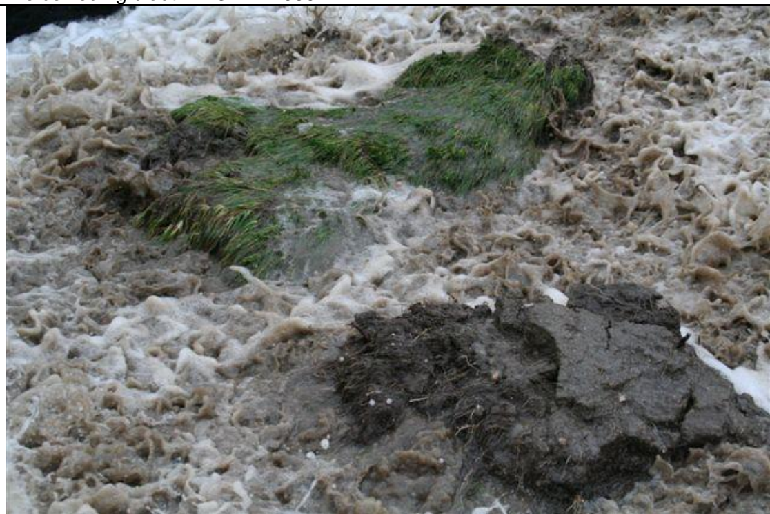
Wegslaan andere stukken, vergroting kaal kleioppervlak 13:28 2066/2067
