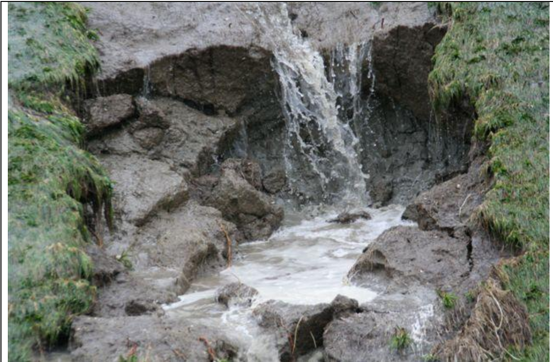
Uitbreiding in breedte en diepte 13:57 2165
