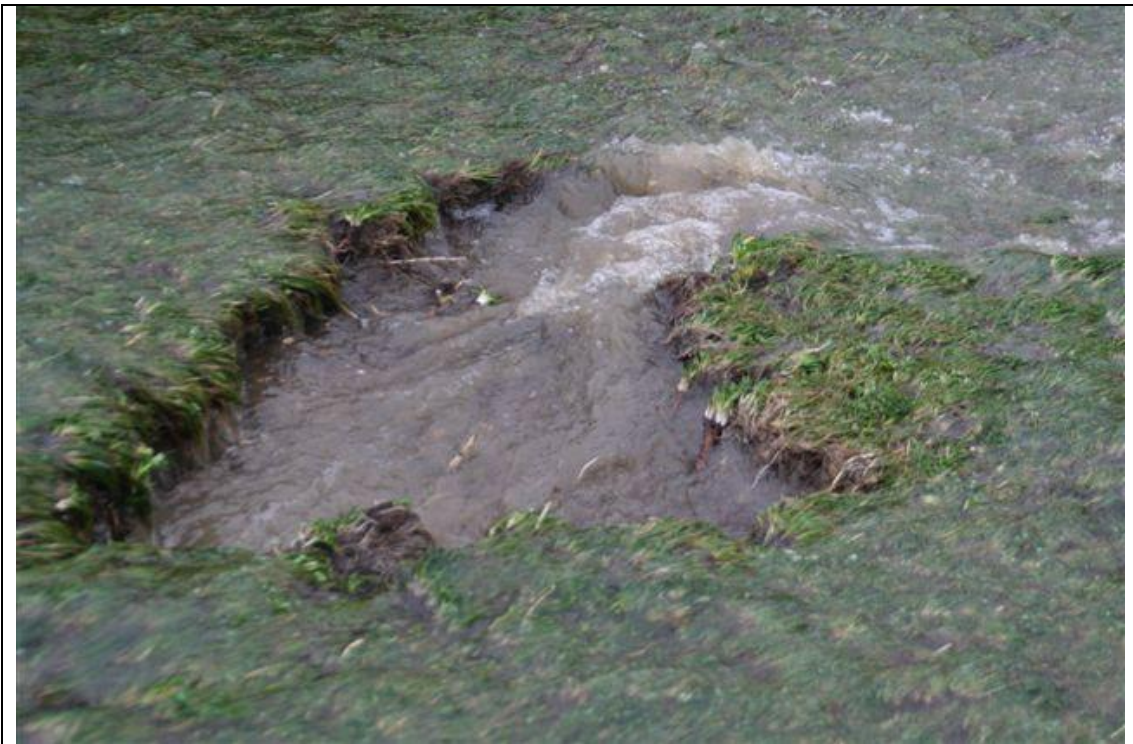
Grote golf slaat de bol weg en onmiddellijke vorming tweede bol 13:23
