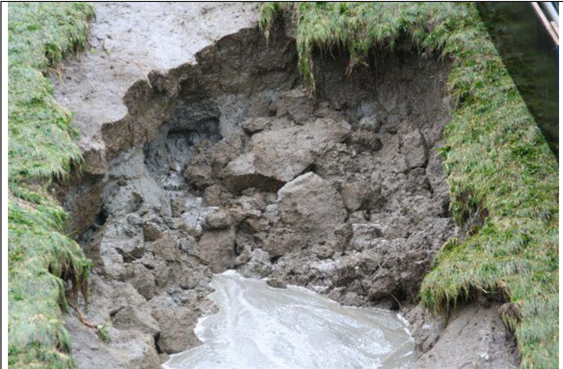
Doorgaande head cut (instabiel klif), zonder water 14:11 2179/2180
