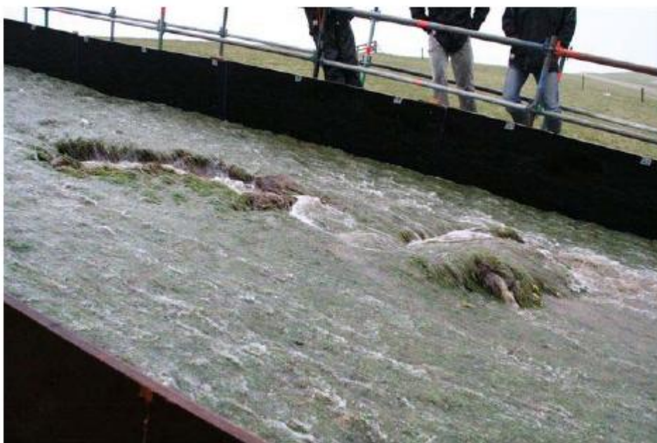
Figuur 4.7 Vorming van een tweede bol direct na het ontstaan van het gat; teststrook 4
