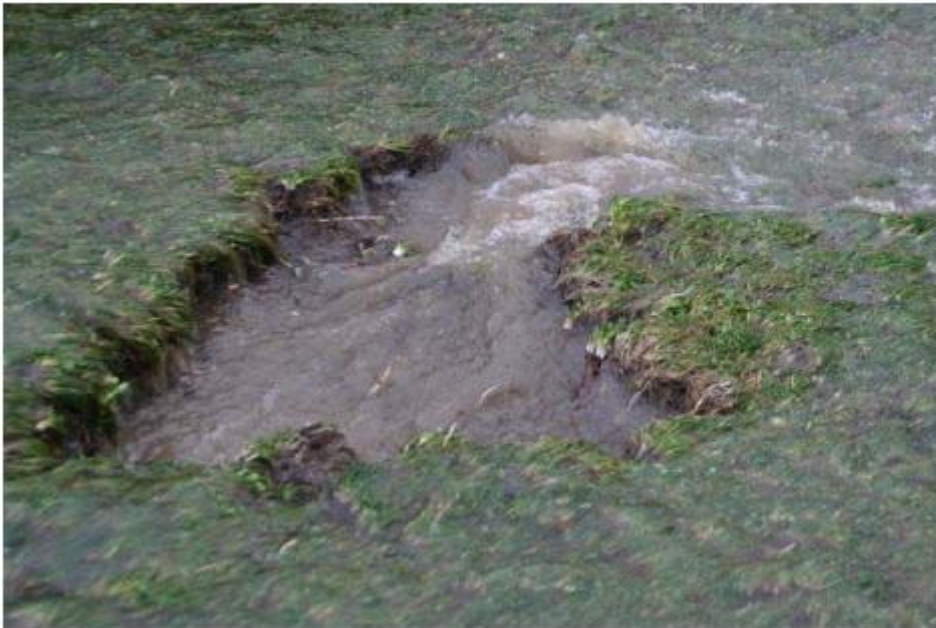
Figuur 4.6 Schade direct na openbreken bol; teststrook 4
