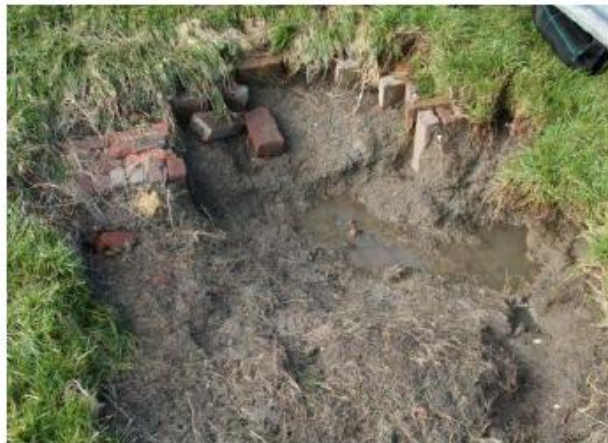
Figuur 4.2 Eindsituatie teststrook 2 (rechts overgang bij teen talud)
