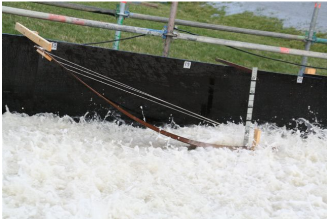
Foto 17. De “surfplank” voor het meten van de laagdikte (Boonweg)
