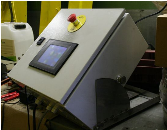
Foto 1. Kast in frame met PLC en noodknop Foto 2. Achterzijde PLC
