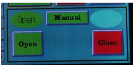
Foto 16. Manuele bediening, waarbij linksboven wordt aangegeven dat de klep helemaal open is.
