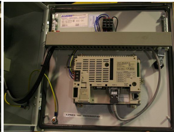
Foto 1. Kast in frame met PLC en noodknop Foto 2. Achterzijde PLC
