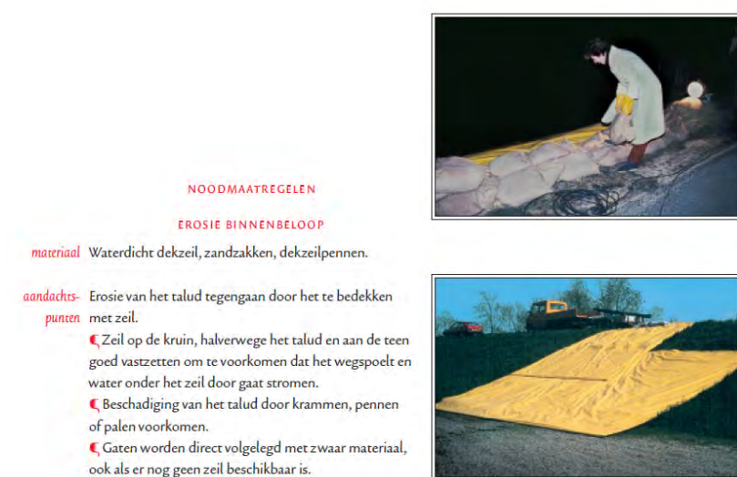
Figuur 5.3 Noodmaatregelen t.a.v. erosie binnenbeloop volgens het rode boekje
