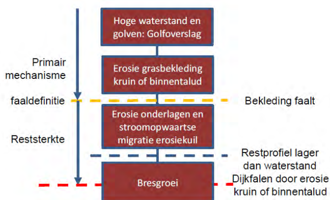
Figuur 1.1 Gebeurtenissen leidend tot falen dijk als gevolg van erosie van de grasbekleding op de kruin of het binnentalud
