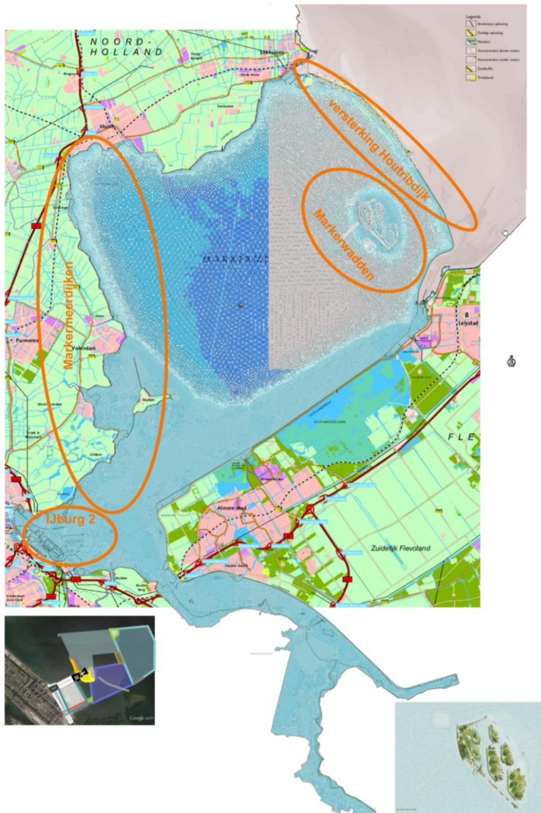
Figuur 3.2 Rekenrooster Markermeer, IJmeer, Gooimeer, Eemmeer en Eem voor nieuwe 6 e generatie modelschematisatie met lokaties ontwikkelingen in oranje omlijnd. Linksonder contouren van IJburg 2. Rechtsonder ontwerp eerste fase Marker Wadden zoals dat nu wordt aangelegd.
