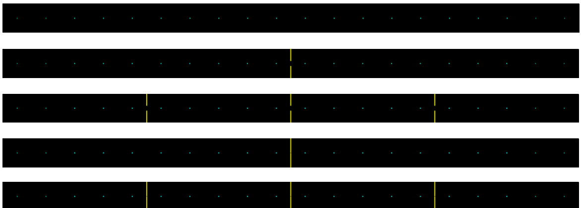
Figuur D.3 Schematische kanaal met van boven naar beneden: geen vernauwing, een vernauwing met 500 m opening, drie vernauwingen met 500 m opening, een vernauwing met 60 m opening en drie vernauwingen met 60 m opening.
