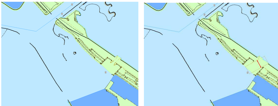
Figuur 4.14 Detail Harderwijk van originele Baseline schematisatie veluwerandmeren_j10_5-v1 zoals gebruikt voor uiteindelijke D-Flow FM model met lokale 5 m resolutie bij het aquaduct (links) en specifiek aangepaste Baseline schematisatie veluwerandmeren_j10_5-v1_edit voor 5 e generatie WAQUA model (rechts)
