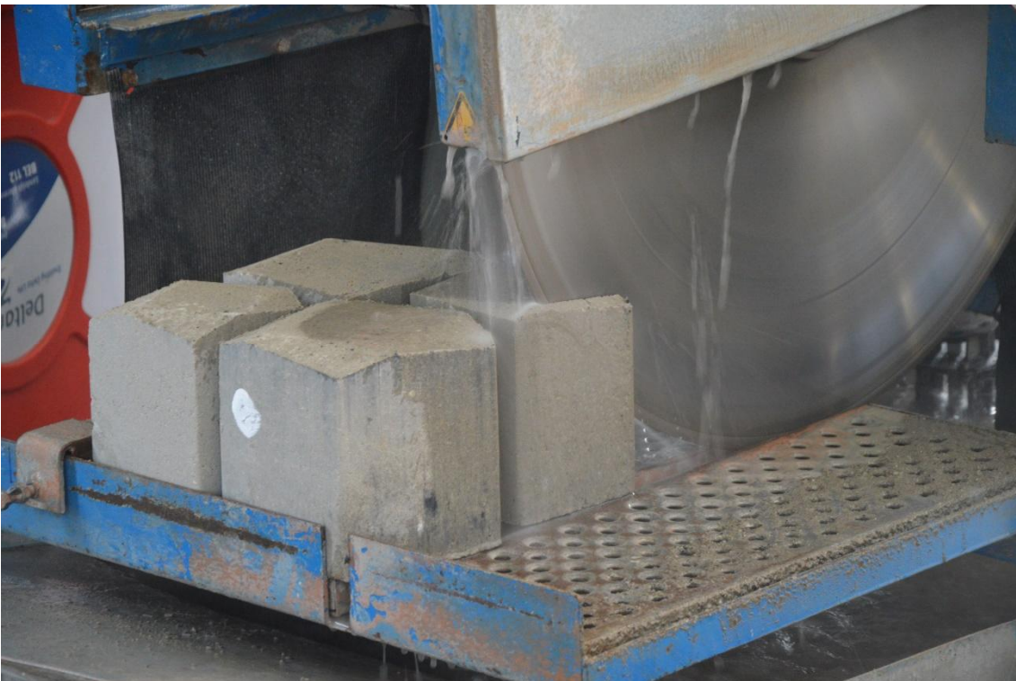
Figuur E.4 Op maat zagen van een Quattroblock voor de rand van het talud
