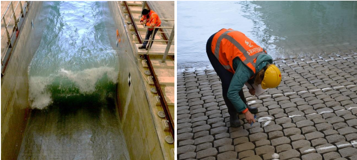
Figuur 4.2 Monitoring van schade tijdens de proeven (links) en het meten van de uitspoeldiepte na afloop van de proeven (rechts)
