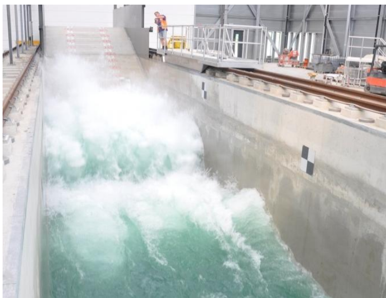
Figuur C.1 Golfaanval op testsectie van Basalton Quattroblocks
