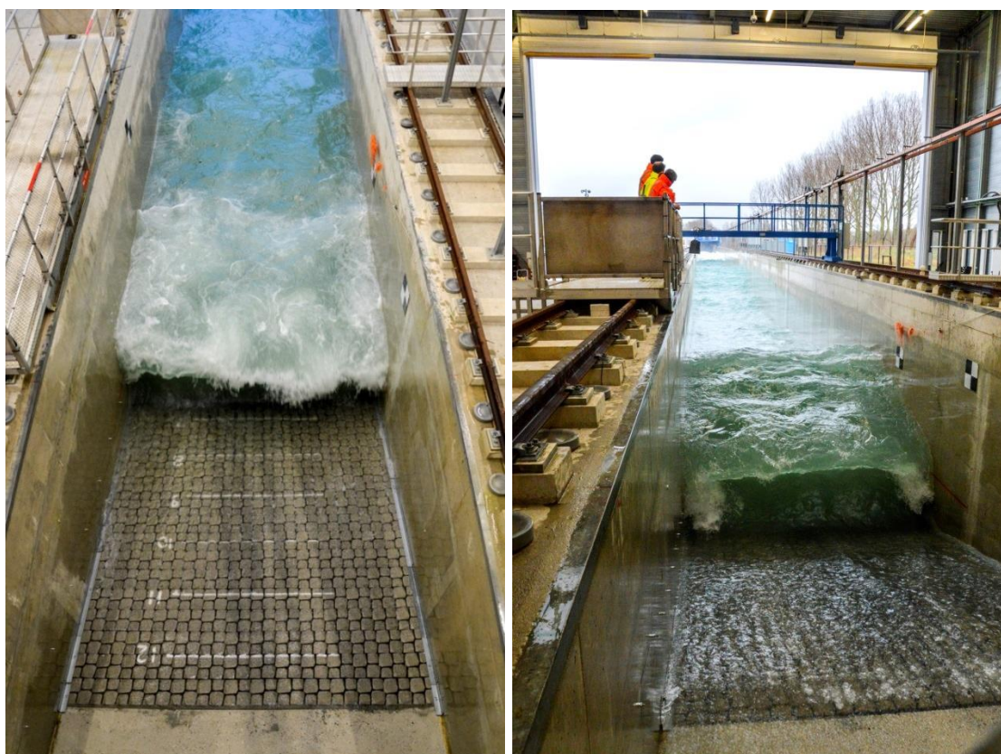
Figuur 4.1 Golfbelasting op talud met Basalton Quattroblocks
