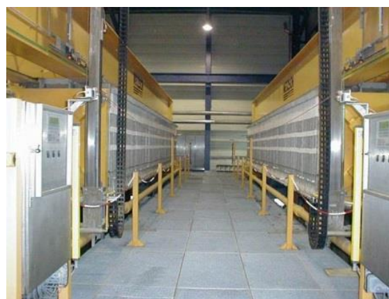
Figuur 23: Ligging METHA Anlage Hamburg, overpompen van baggerspecie naar de verwerkingsite (bron: Filmförderung Hamburg Schleswig-Holstein) en membraankamerfilterpers in de METHA Anlage (bron: Fachagentur Nachwachsende Rohstoffe)
