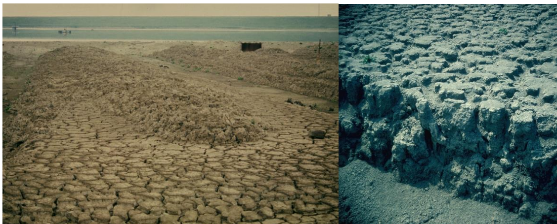
Figuur 12: Euroklei op ruggen gezet (links) en geproduceerde Euroklei (rechts, 1987) -Rijkswaterstaat / Jan Muijs / Ronald van Etten)
