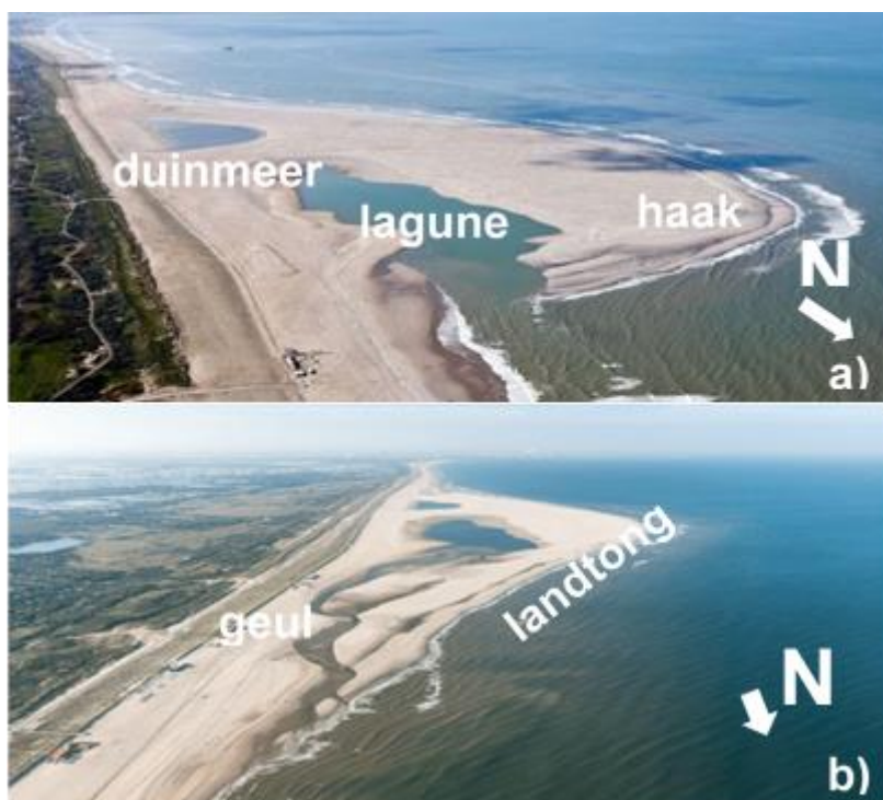
Figuur 1.1 Zandmotor tijdens laag water kort na aanleg in 2011 (links) en veranderd door het proces van erosie in 2013 (rechts)
