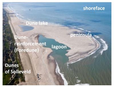
Figure 1.1 Sand Motor after realization in 2011 (Rijkswaterstaat / J. van Houdt)
