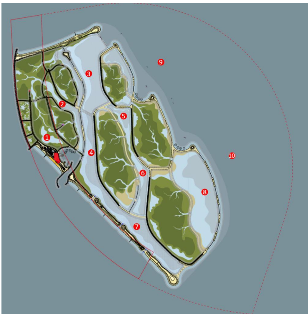
Figuur 8. Voorstel voor een netwerk van locaties met mini-meetpalen voor continue metingen van waterhoogte, lichtinval en watertemperatuur.
