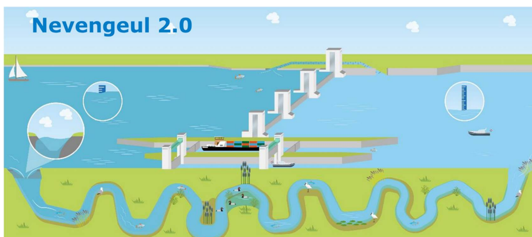
Figuur C.1 Schematische presentatie van het conceptuele idee voor een Nevengeul-2.0 bij een stuwcomplex.
