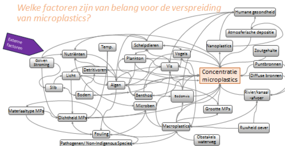
Figuur 3.1 Conceptueel model waarbij de relaties die van belang zijn voor de verspreiding van microplastics in het aquatische milieu worden weergegeven. Hierin worden ook elementen weergegeven die van belang zijn voor de effecten van microplastics op het milieu (toepassing 4).
