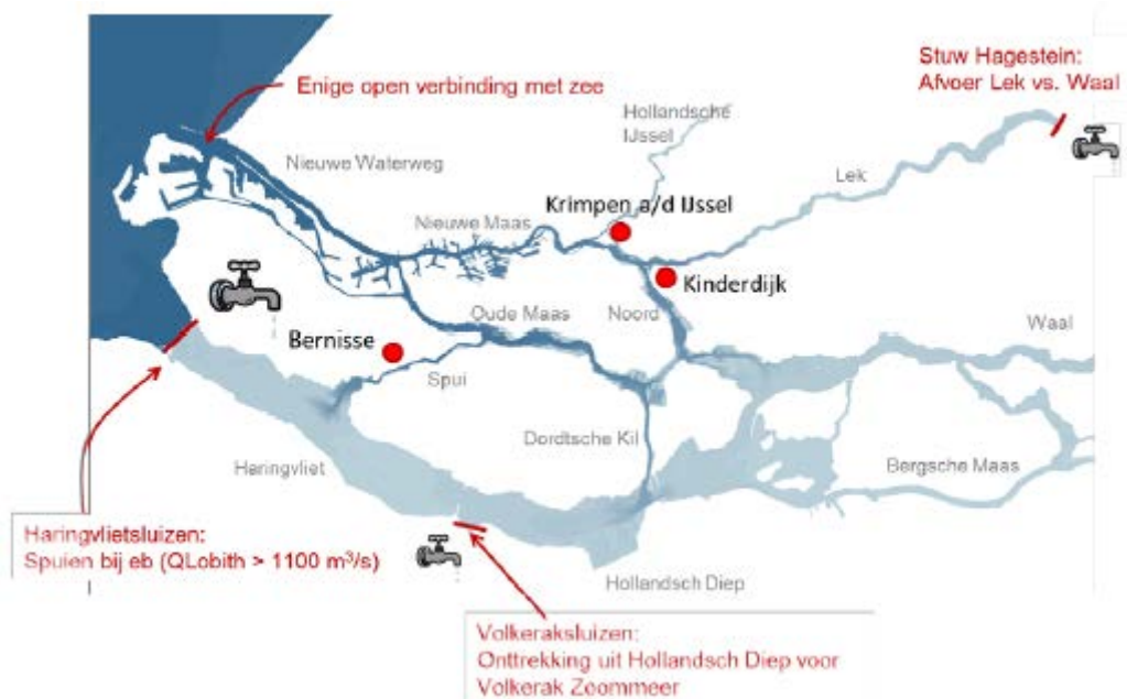
Figuur 4.1 Overzichtskarta van de Rijn-Maasmonding met de belangrijkste meetlocaties en stuurknoppen (bron: Huismans et al., 2018)
