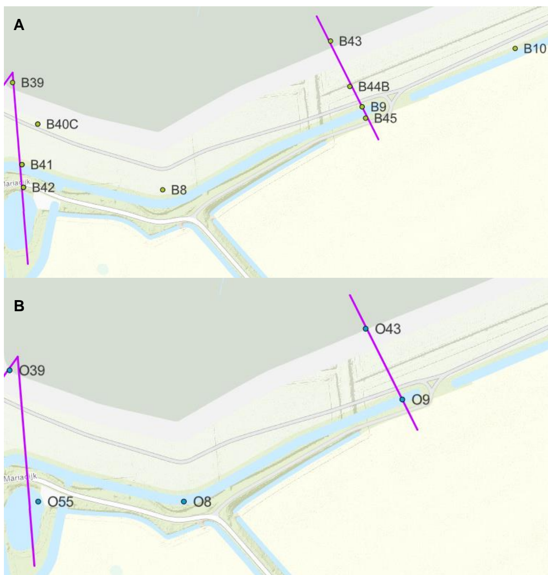
Figuur 12A en B: Overzicht monitoringslocaties op de zuidelijke dijk. Grondwaterlocaties zijn aangegeven in groen in A, oppervlaktewater locaties zijn aangegeven in blauw in B. In paars zijn de verschillende meetraaien weergegeven.
