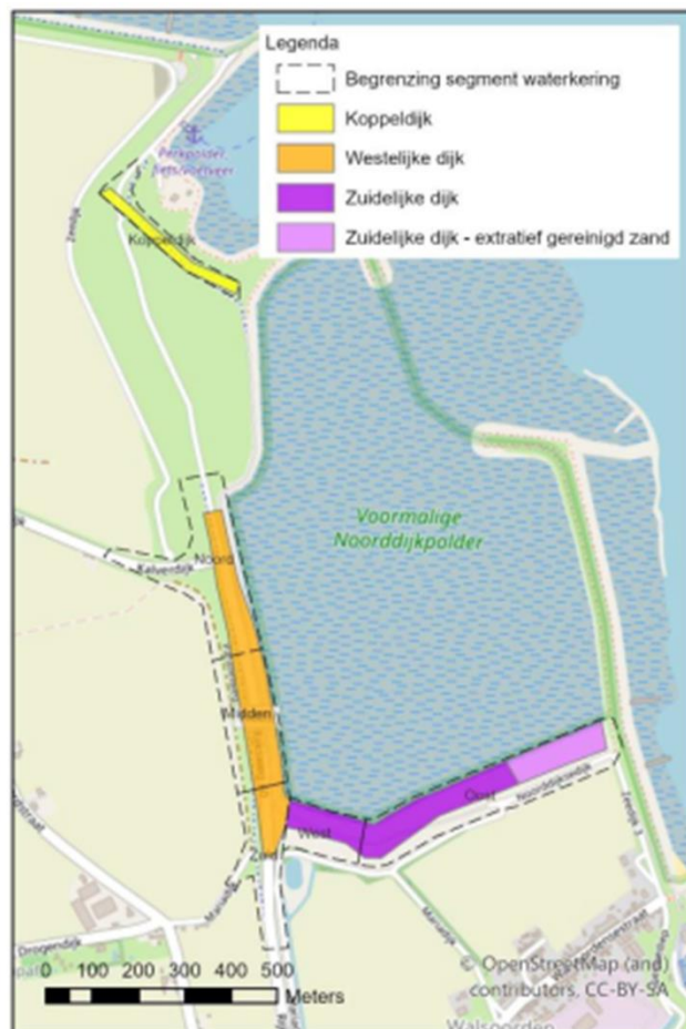
Figuur 4. TGG is toegepast in delen van de Koppeldijk, westelijke dijk en zuidelijke dijk.
