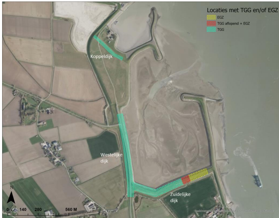
Figuur 2.2. TGG is toegepast in delen van de Koppeldijk, westelijke dijk en zuidelijke dijk.
