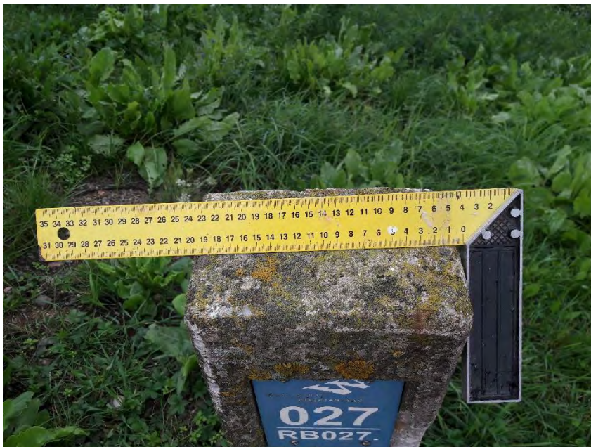
Figuur 7.2 Paaltje met een diameter (breedte) groter dan 15 cm
