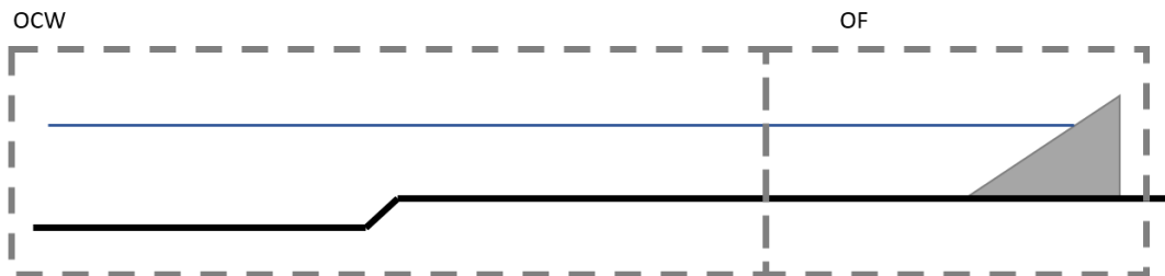
Figuur 2.1 Numerieke opstelling van het domein in OCW en OpenFoam. Dit is een schematische tekening en niet op schaal.
