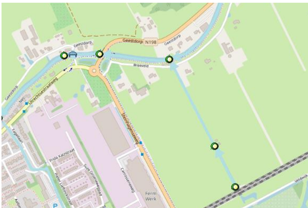
Figur 0.3: Onnodige nodes die zorgen voor een onregelmatige rekenafstand
