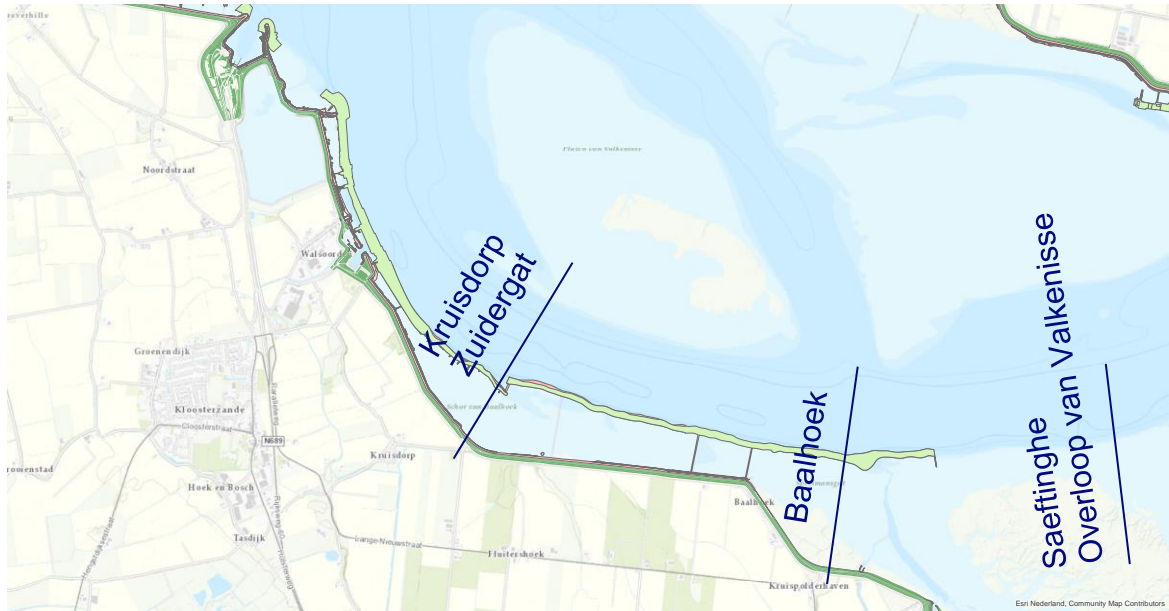
Figuur 4-27 Geulwandverdediging Zuidergat, Baalhoek en Overloop van Valkenisse (met raaien) aansluitend op oeverwerken (in lichtgroen) bij Walsoorden. Dijkbekleding in donkergroen. Shapefiles in ARCGIS.
