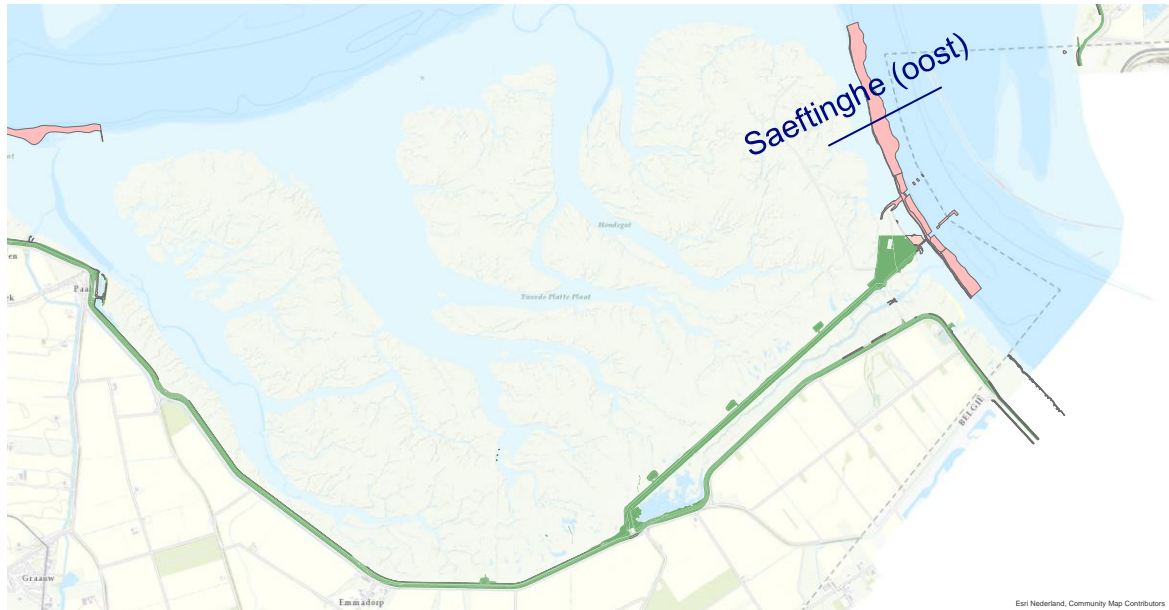
Figuur 4-45 Geulwandverdediging bij Land van Saeftinghe (Oost) met oeverwerken (roze). Hier is ook de gaspijpleiding te zien, het Sieperdaschor en de dijken van de Hedwige- en andere polders (donkergroen). (Shapefiles in ARCGIS).
