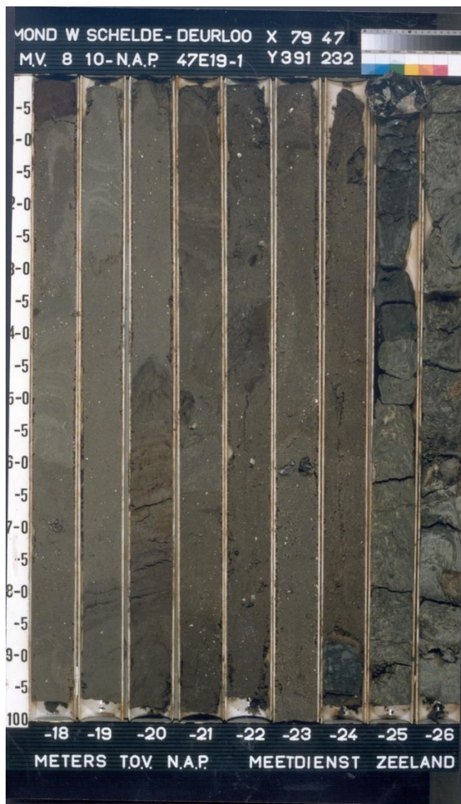
Figuur 2-2. Foto van boring BS100118 - .zijn twee kleilagen tussen -16 en -20 m NAP gedateerd op het Subboreaal (5660-2400 jaar geleden; Cleveringa, 1990). De diepste kleilaag daarvan ligt ongeveer tussen -19,5 en -19,8 m NAP; de bovenste kleilaag daarvan is niet zichtbaar in de foto. De kleilaag vanaf circa -24 m NAP bestaat uit klei van de Rupel Formatie.
