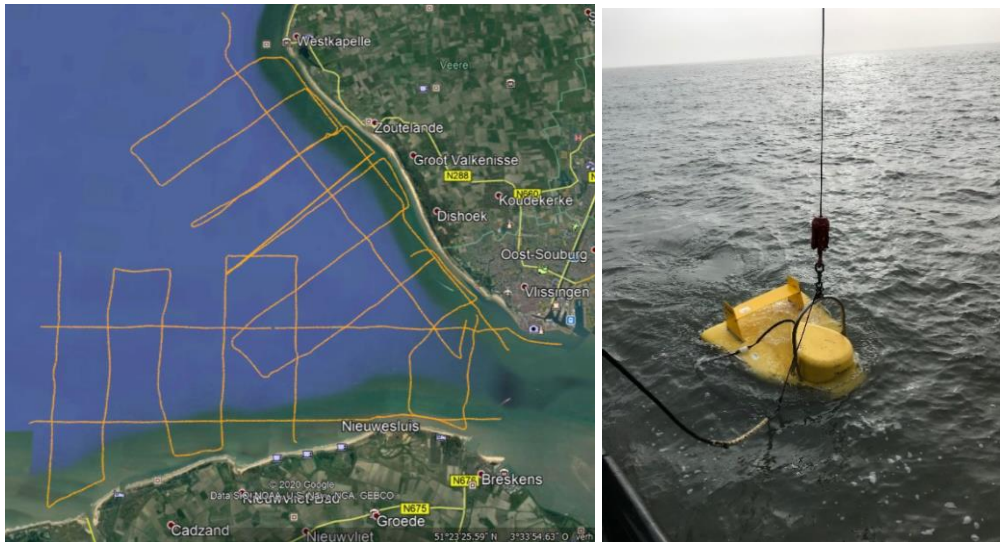
Figuur Fout! Gebruik het tabblad Start om Heading 6 toe te passen op de tekst die u hier wilt weergeven.-1: Overzicht van de gevaren lijnen in 1996 (links) en het tewaterlating van de X-Star sleepvis type SB-512 (rechts). De SB-408, gebruikt voor de 1996 survey was iets groter.
