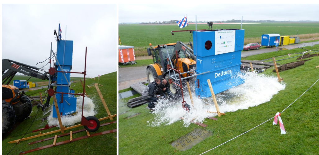
Figuur 3.1 Impressie van de golfklapgenerator
