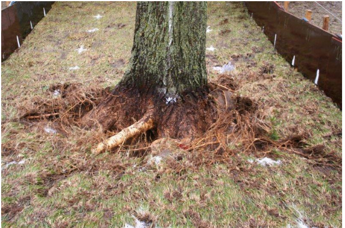
Foto B47 Vechtdijk. Zeeregime met boom, proef 2; Grote erosie boomwortels, zand komt vrij
