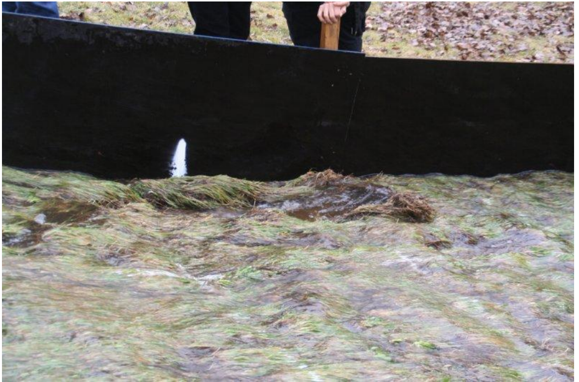
Foto B56 Vechtdijk. Rivierregime, proef 4; Eerste schade
