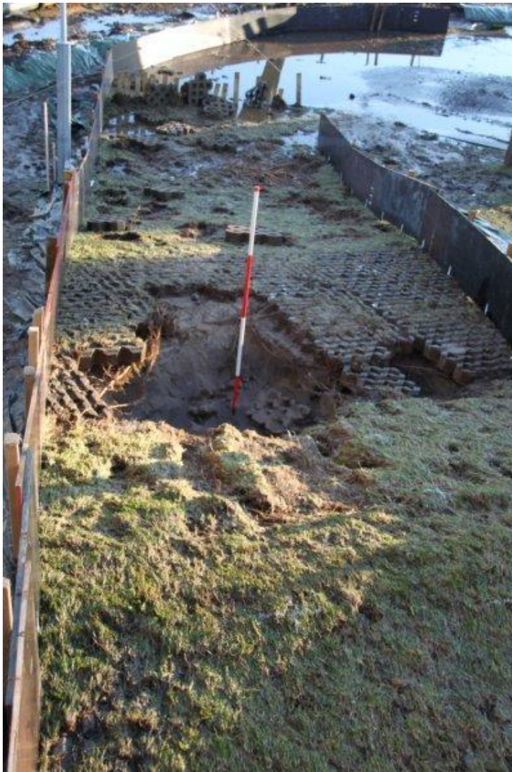
Foto B41 Vechtdijk. Zeeregime met dijkovergang, proef 1; Proef gestopt, overgang bezwiken
