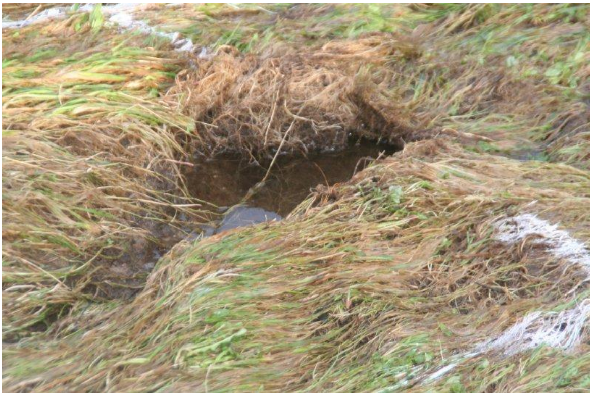
Foto B53 Vechtdijk. Zeer zwaar zeeregime, proef 3; Zand komt vrij door afdeklaag
