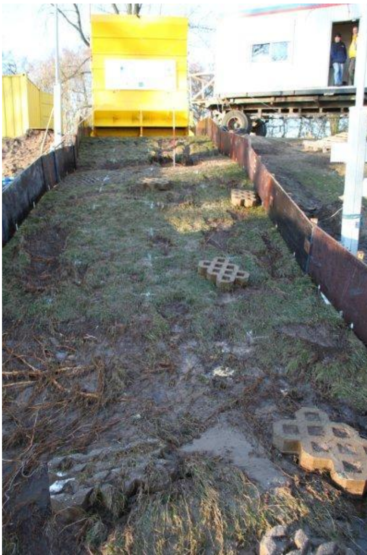
Foto B39 Vechtdijk. Zeeregime met dijkovergang, proef 1; Talud na de proef niet bezwiken
