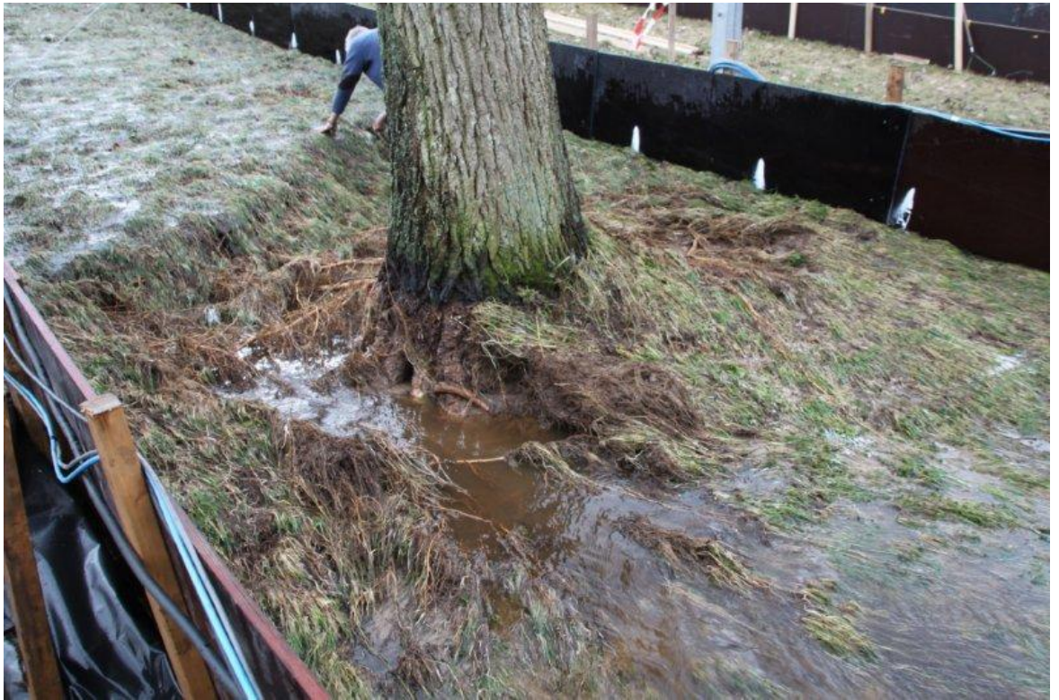
Foto B48 Vechtdijk. Zeeregime met boom, proef 2; Gestopt, headcut erosie bovenstrooms van boom
