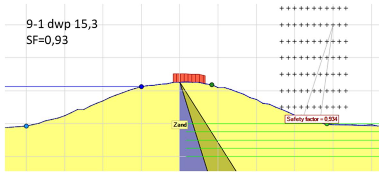
Figuur 2.2 Glijcirkel profiel 9-1 dwp 15,3 scenario overslag
