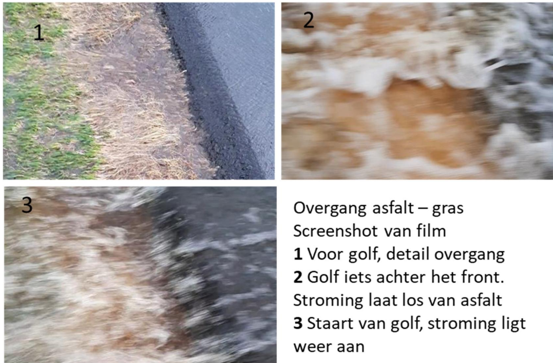
Figuur 3.8 Screenshots van film van golfoverslagvolume die over de rand van het asfalt stroomt. Bij grote volumes liet de stroming los (lucht onder de stroming langs de asfaltrand)
