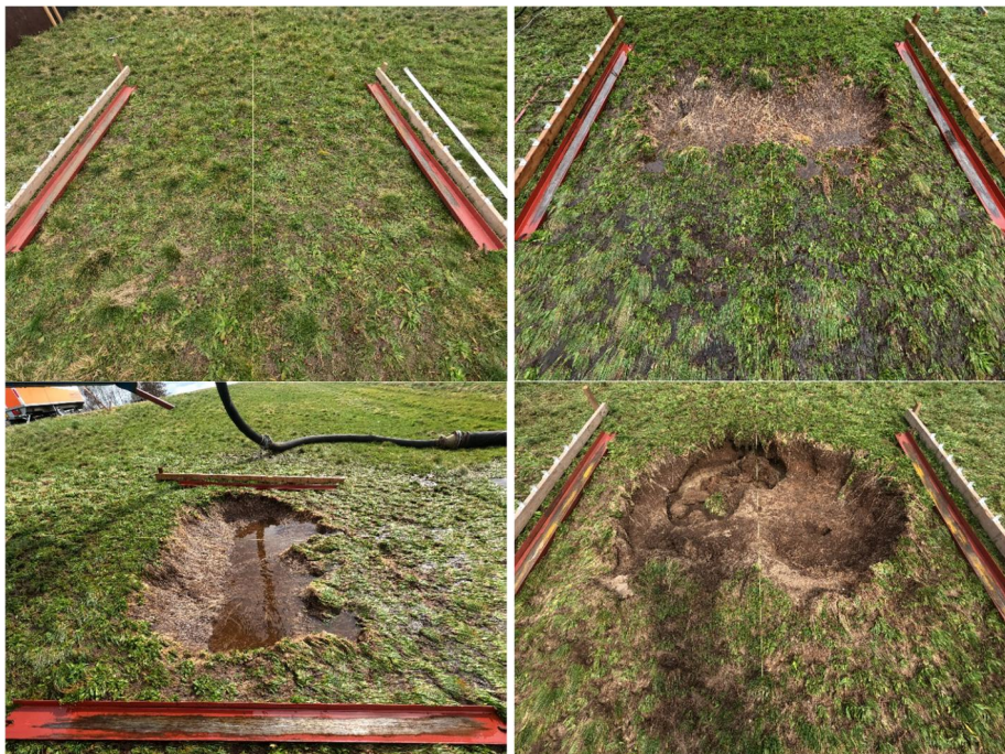
Figuur 2.4 Schadeontwikkeling Testsectie 3A (van links boven met de klok mee: voor de start, na 28 cycli, na 52 cycli en na 69 cycli) falen toplaag
