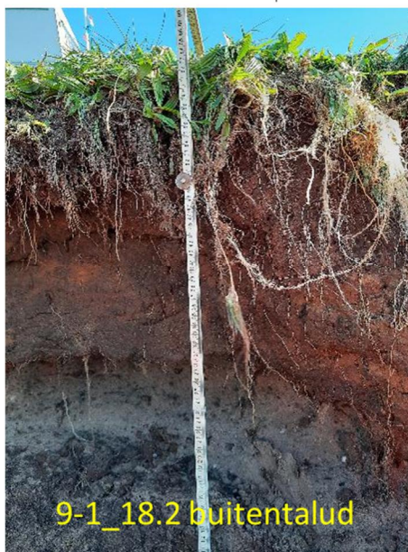
Figuur 3.27 Bodemproefiel 9-1 18.2 buiten stroken 2-1 buitentalud en 2-2 binnentalud
