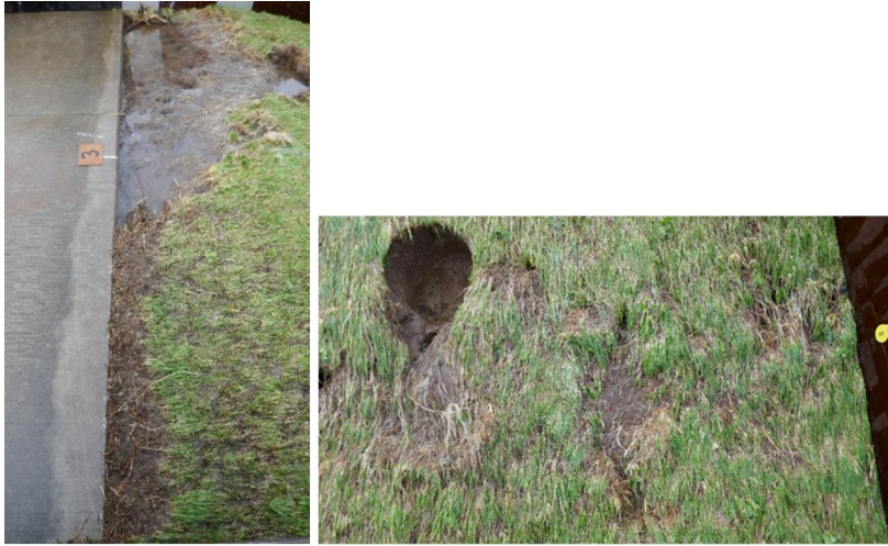
Figuur 3.23 Schade aan overgang betonpad naar gras en rondom een aangebrachte schade op het talud (beide einde proef na 2 uur 50 l/s per m)
