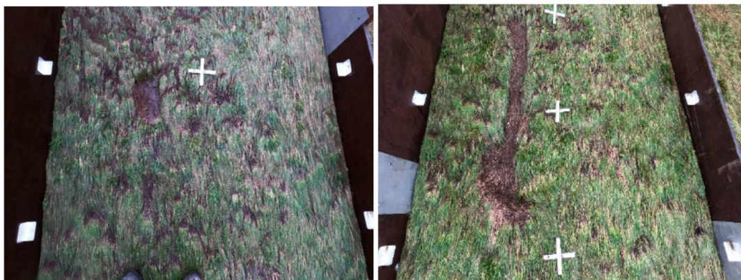
Figuur 3.13 Schade vak 6 (links) na 3,25 uur GO190_1,0 en na 5 uur GO190_1,0 (rechts)
