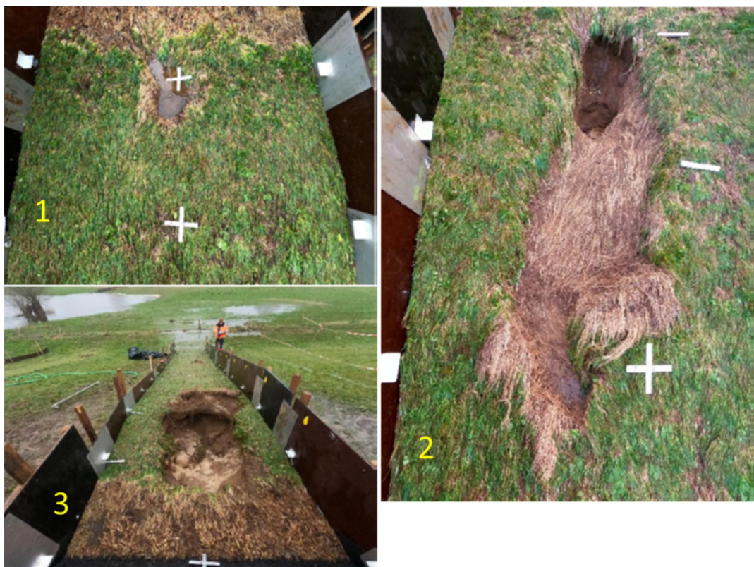
Figuur 3.9 Schade vak 5 bij de kruin (1), falen (2) en resultaat na extra 0,5 uur GO190_1,0 ten opzichte van falen (3)
