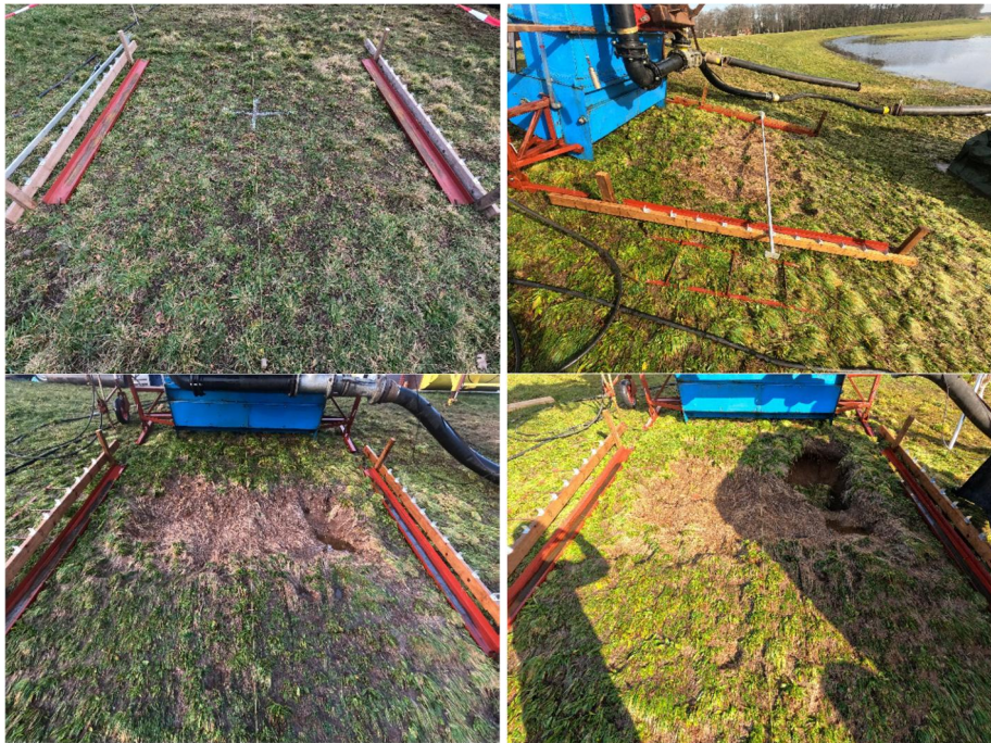
Figuur 2.3 Schadeontwikkeling Testsectie 2A (van links boven met de klok mee: voor de start, na 24 cycli, na 32 cycli en na 36 cycli) falen toplaag
