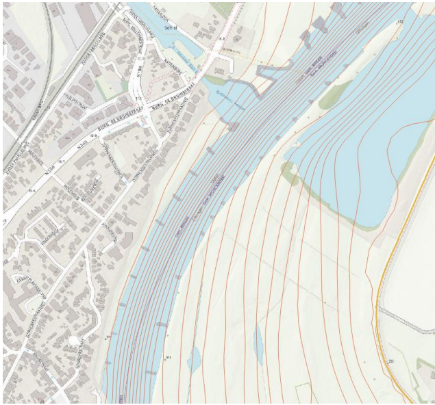
Afbeelding I.6 Voorbeelden van stroomvelden over kribben
