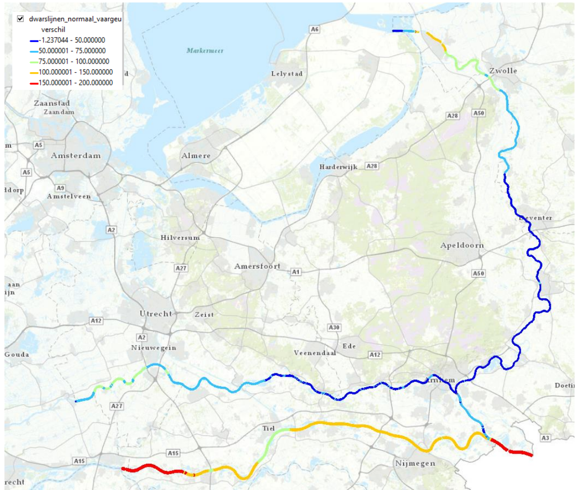
Afbeelding II.4 Kaart voor criterium 3 - Voldoende rivierbreedte aanwezig voor langsdammen (informatie uit Baseline), gedefinieerd als zomerbedbreedte (van zomerdijk tot zomerdijk uit) minus de vaargeulbreedte en schrikruimte in meters
