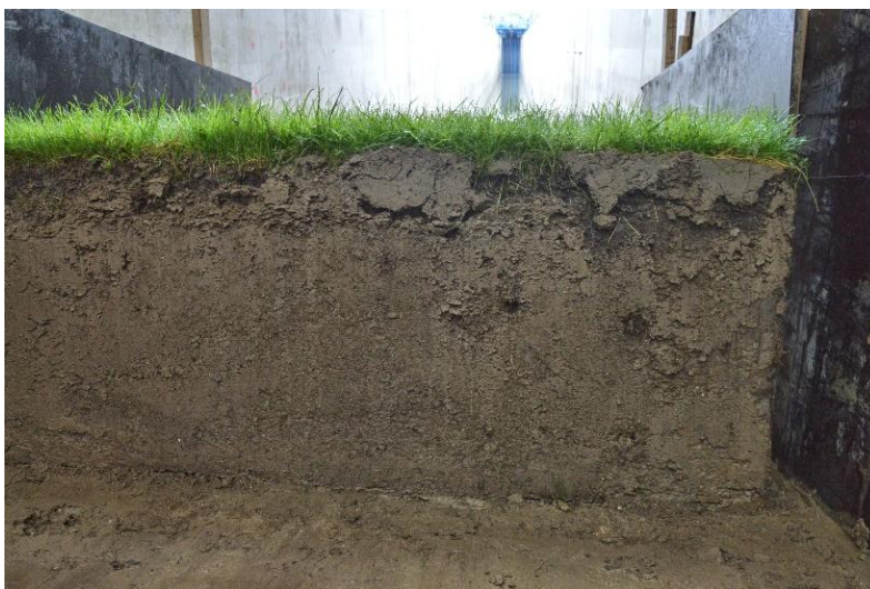
Figuur 4.10 Klei van Holwerd heeft weinig structuurvorming
