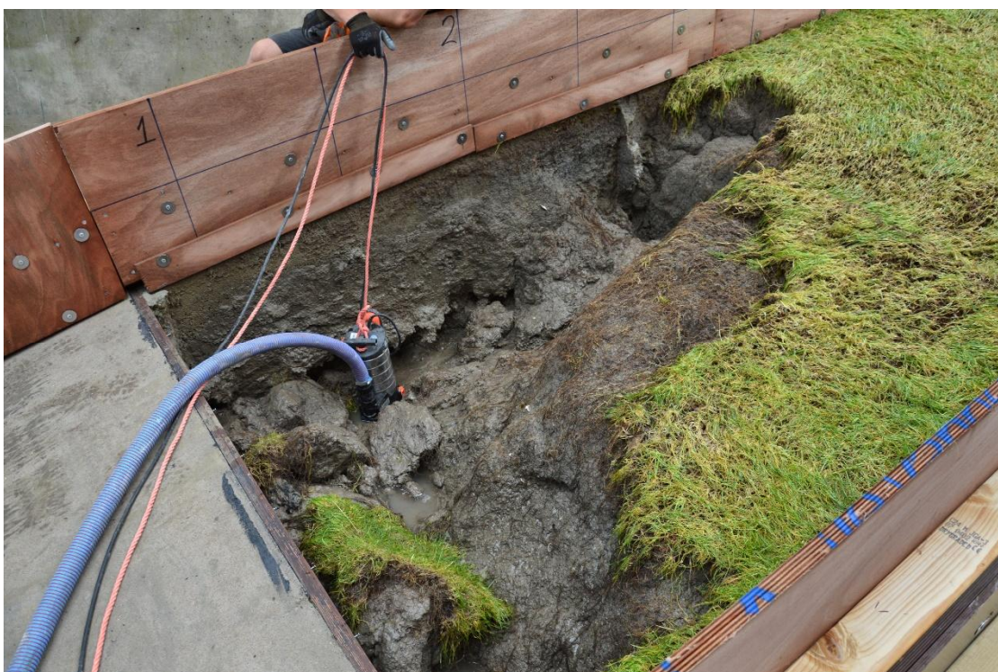
Fig. B-36 Erosiekuil na proef K1_08
