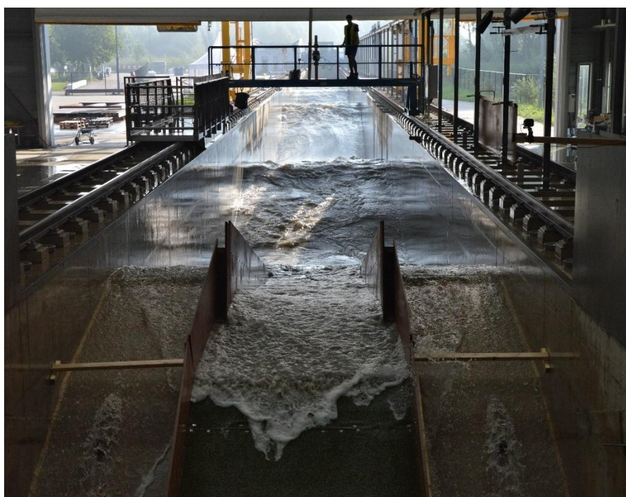
Figuur 6.1 Golven in de Deltagoot met golfoverslag tijdens proef K2_07
