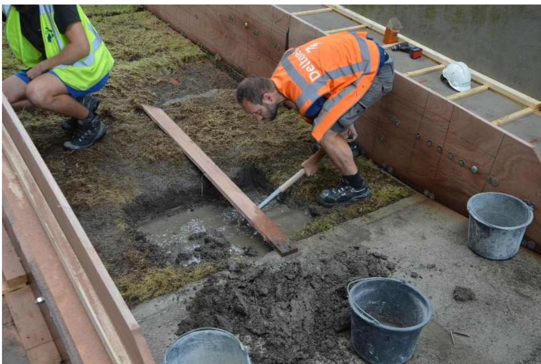
Figuur 5.7 Aanbrengen van een kunstmatige klif na K2_07 in de kleibekleding om de erosie te stimuleren.
