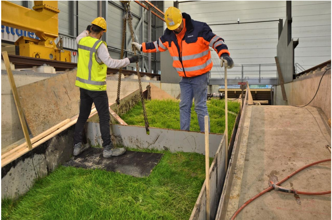
Fig. B-89 Lichten van de zijkant van een stalen mal rond een kleiblok met gras
