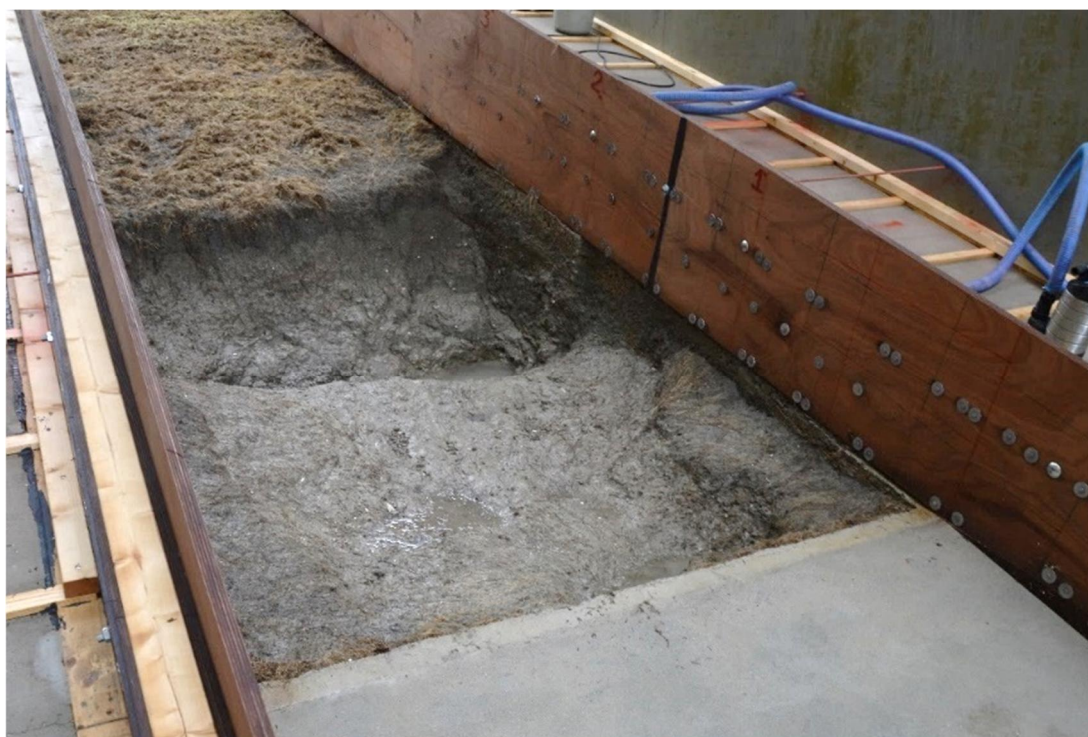
Figuur 6.10 Vanaf proef K3_06 is er een duidelijke klif in het tweede kleiblok.
