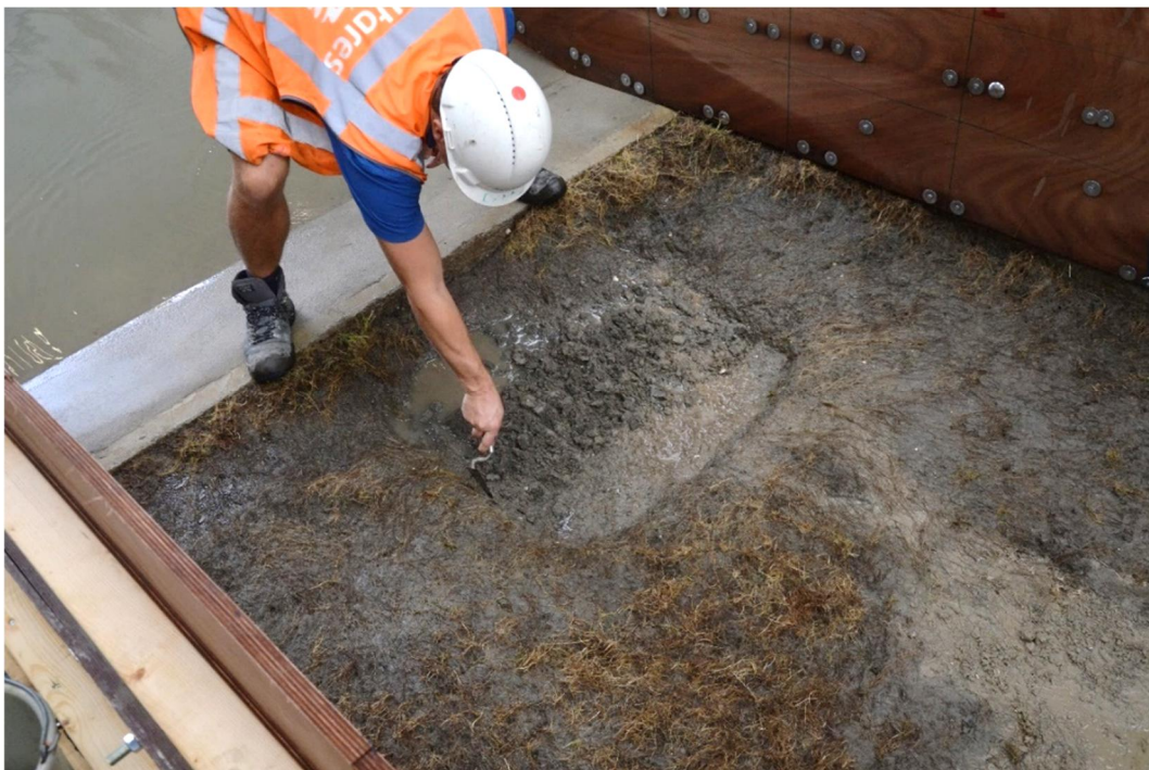
Figuur 5.9 Kleioppervlak is plaatselijk wat ruw gemaakt met een troffel na proef K3_01
