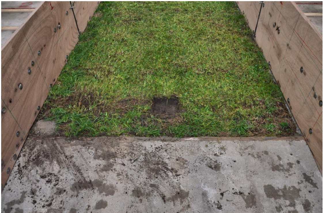
Fig. B-121 Kunstmatige schade die voor proef K5_01 is aangebracht ( 20 \times 20 \times 5 \text{ cm}^3 )
