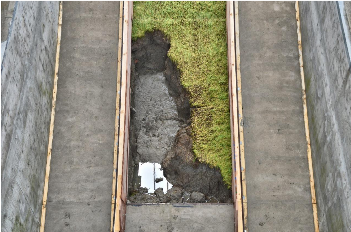
Fig. B-39 Erosiekuil na proef K1_09
