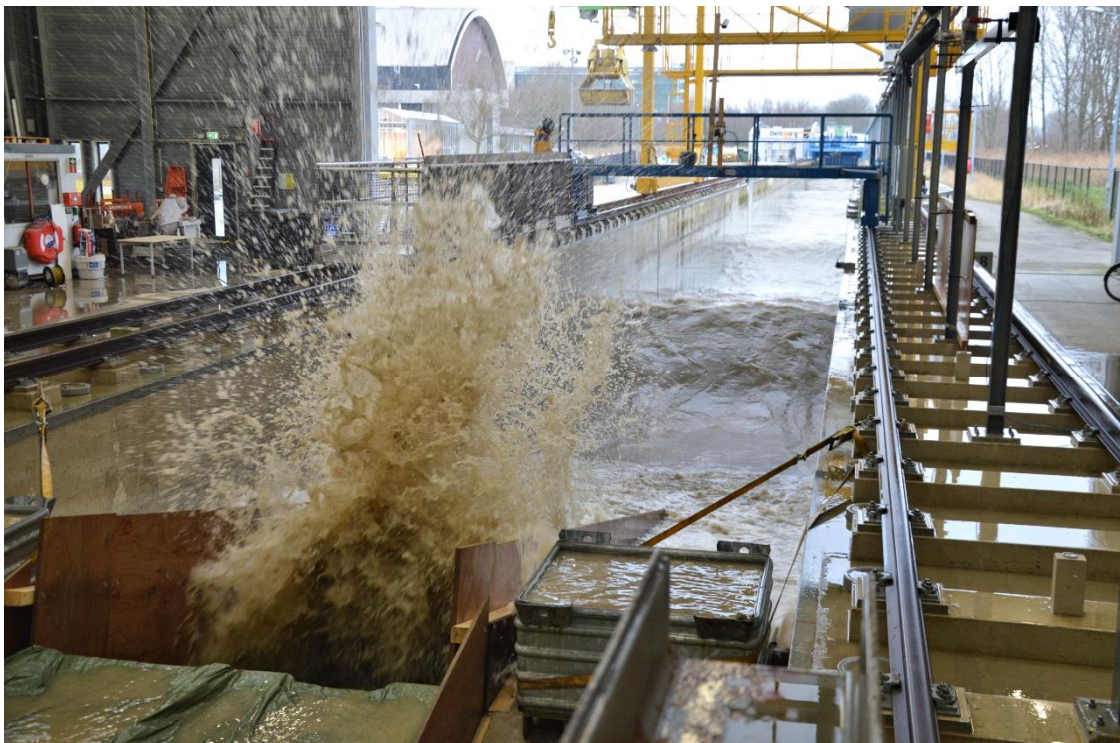
Fig. B-146 Tijdens proef K6_10: de golf klapt tijdens de golfloop tegen de erosieklif
