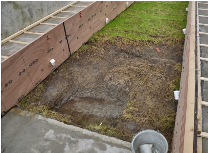
Figuur 4.13 Erosie van de kleibekleding met gras voor aanvang van proef K3-01
