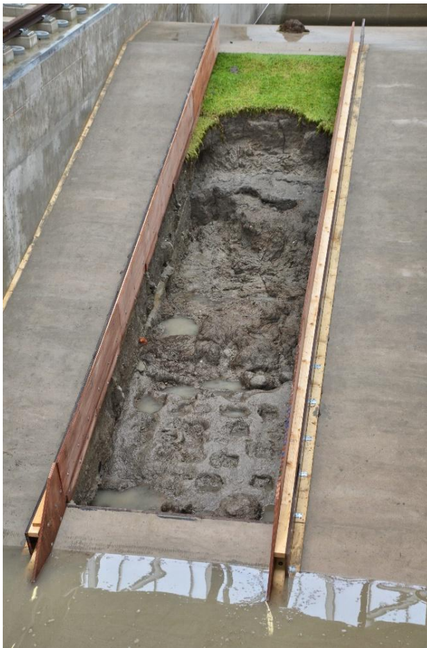
Fig. B-52 Erosiekuil na proef K1_13
