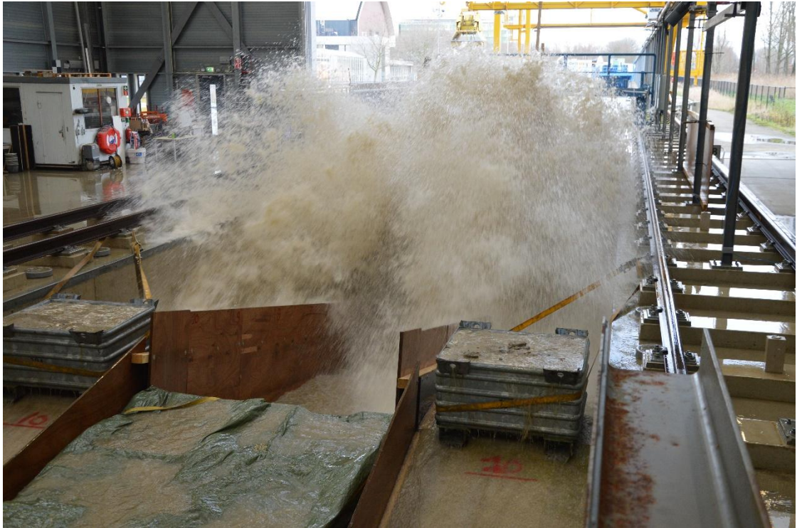
Fig. B-143 Tijdens proef K6_09: de golf klapt tijdens de golfoploop tegen de erosieklif
