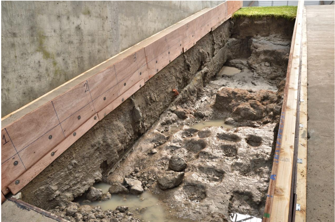
Fig. B-53 Erosiekuil na proef K1_14
