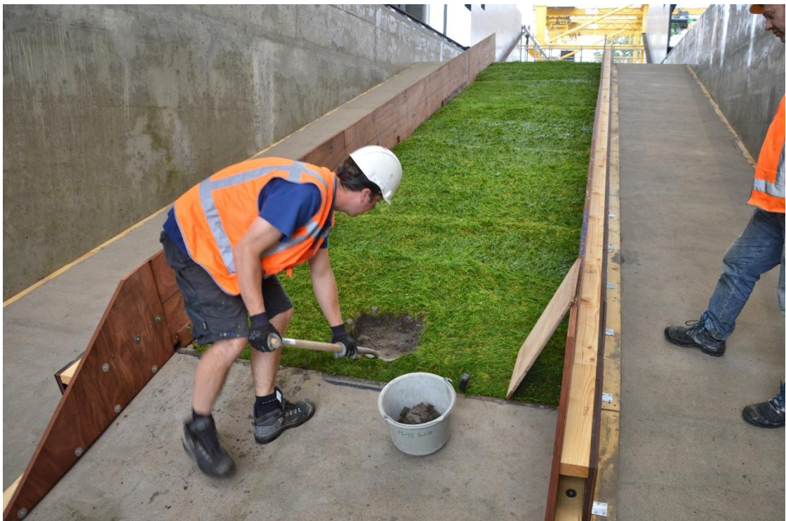
Fig. B-30 Kunstmatige schade vóór proef K1_05
