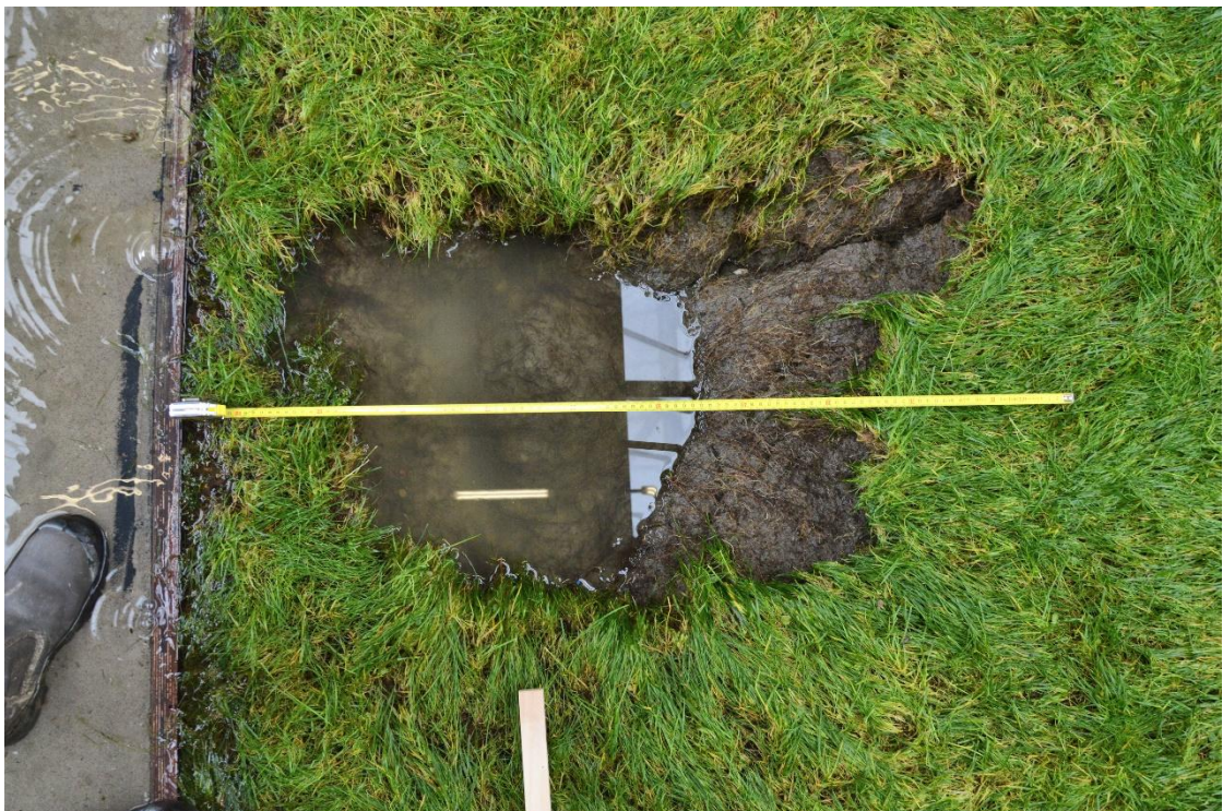
Fig. B-32 Erosiekuil na proef K1_05
