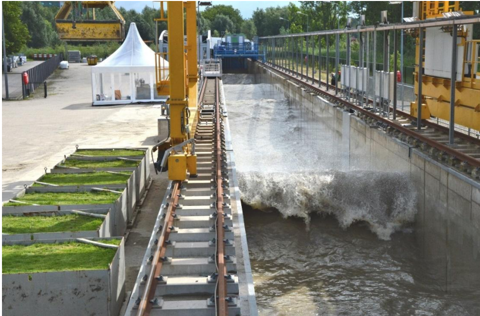
Figuur 1.4 Deltagoot van Deltares met naast de goot kleiblokken met gras in stalen mallen en een tent met twee kleiblokken met gras die een kunstmatige hete en droge zomer doormaken (zie paragraaf 2.2.2)
