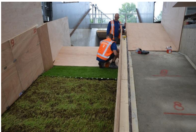
Figuur 4.14 Verhoging van de kruin na proef K3_03
