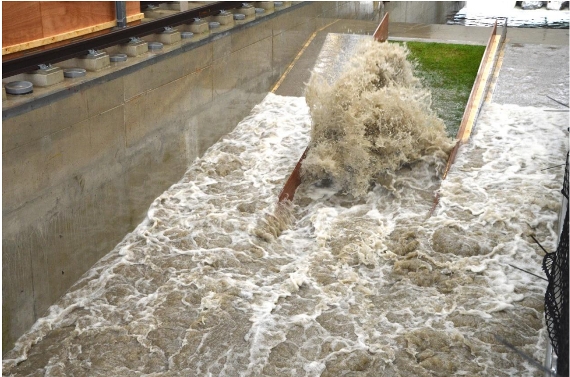
Fig. B-43 Tijdens golfploop botst het water tegen de erosieklif en spat omhoog (proef K1_11)
