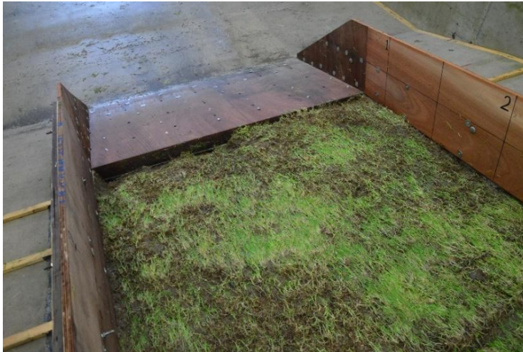
Figuur 6.13 Erosie bij de overgang na proef K4_01
