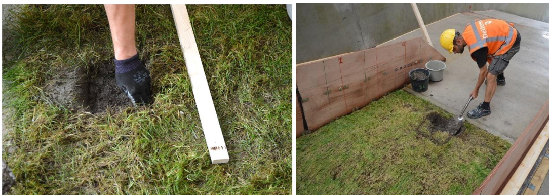
Figuur 5.2 Kunstmatige schade aan de grasbekleding (links na K2_01; rechts na K2_02)
