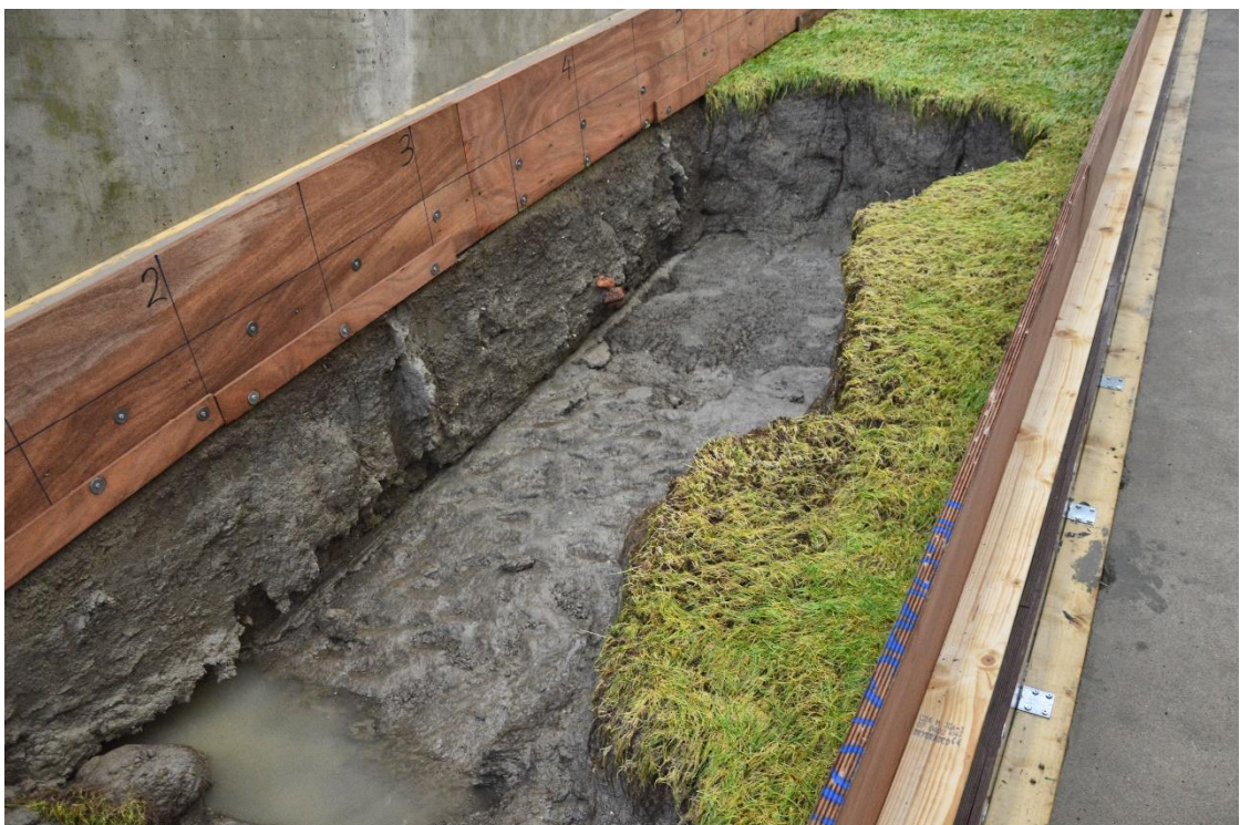
Fig. B-40 Erosiekuil na proef K1_10
