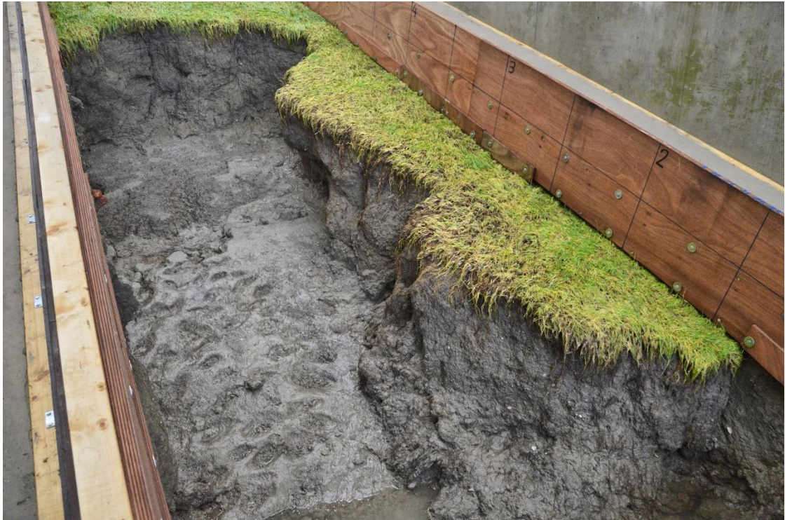
Fig. B-41 Erosiekuil na proef K1_10
