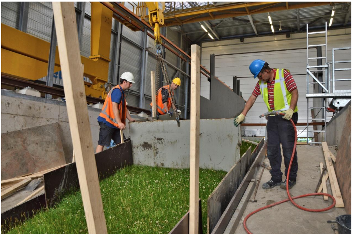
Fig. B-18 Zijwand van een kleiblok met gras eruit trekken
