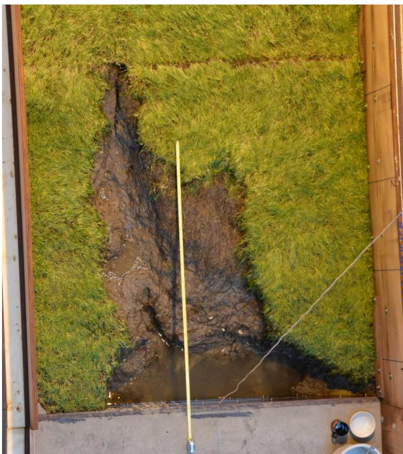
Fig. B-35 Erosiekuil na proef K1_07
