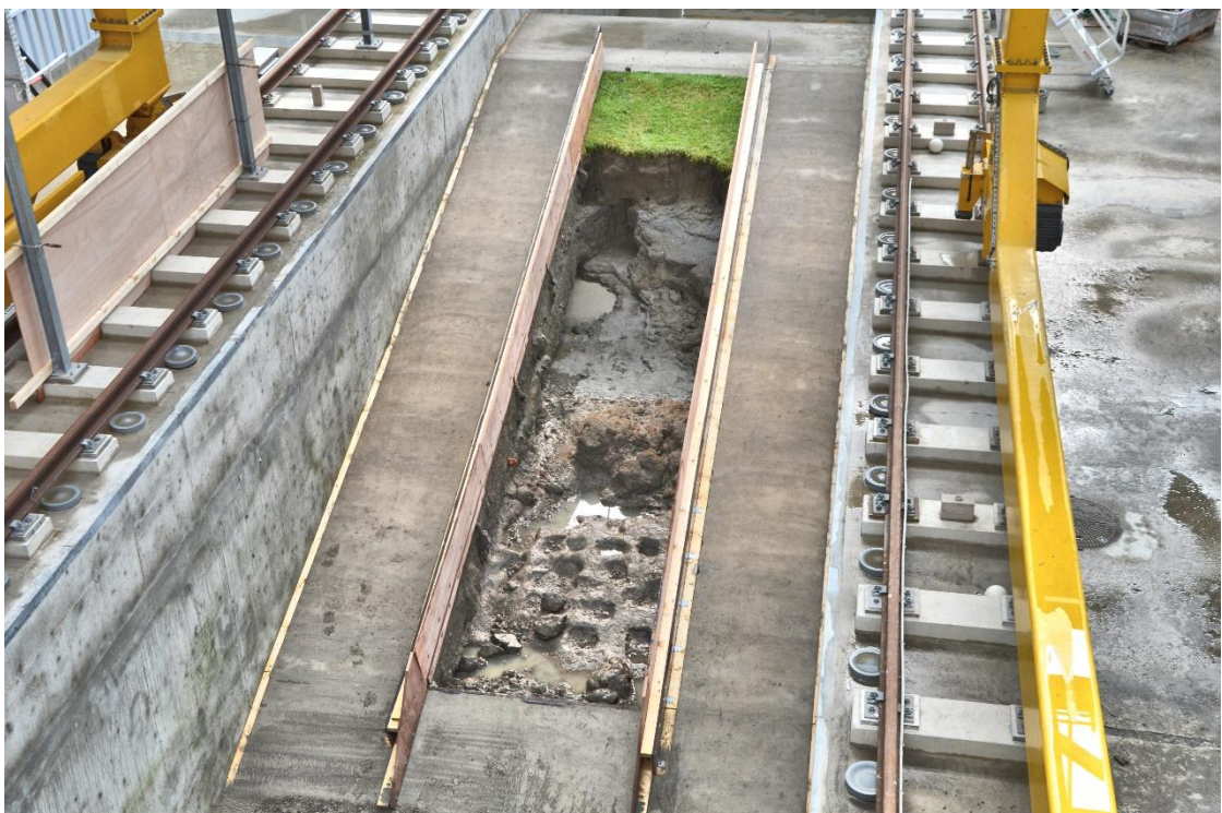
Fig. B-54 Erosiekuil na proef K1_14
