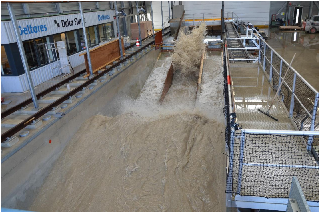
Fig. B-151 Tijdens proef K6_12: de golf klapt tijdens de golfoploop tegen de erosieklif
