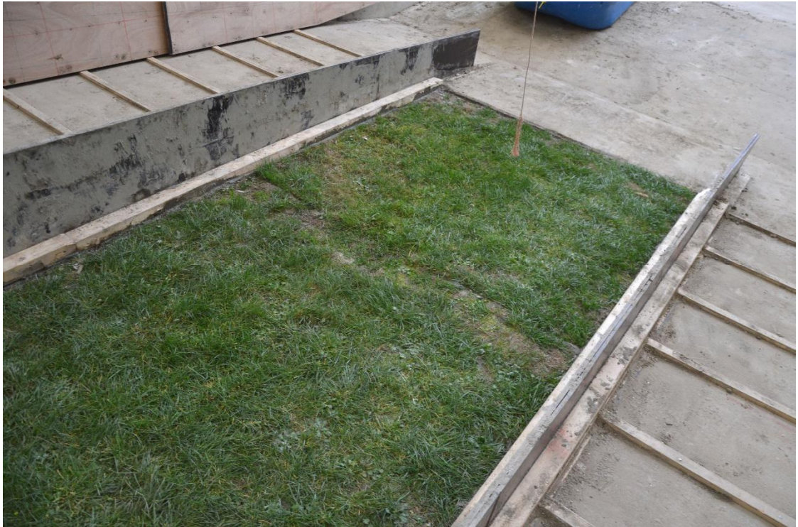
Fig. B-119 Onderste twee Grasblokken hebben een zeer hete en droge zomer doorgemaakt en hebben daarna in het najaar weer water gekregen, maar zijn daardoor niet volledig hersteld.
