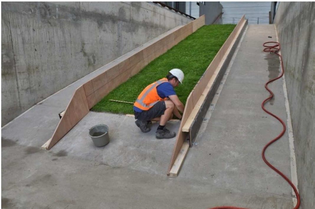
Figuur 4.4 Boventalud van de (toekomstige) Lauwersmeerdijk in de Deltagoot
