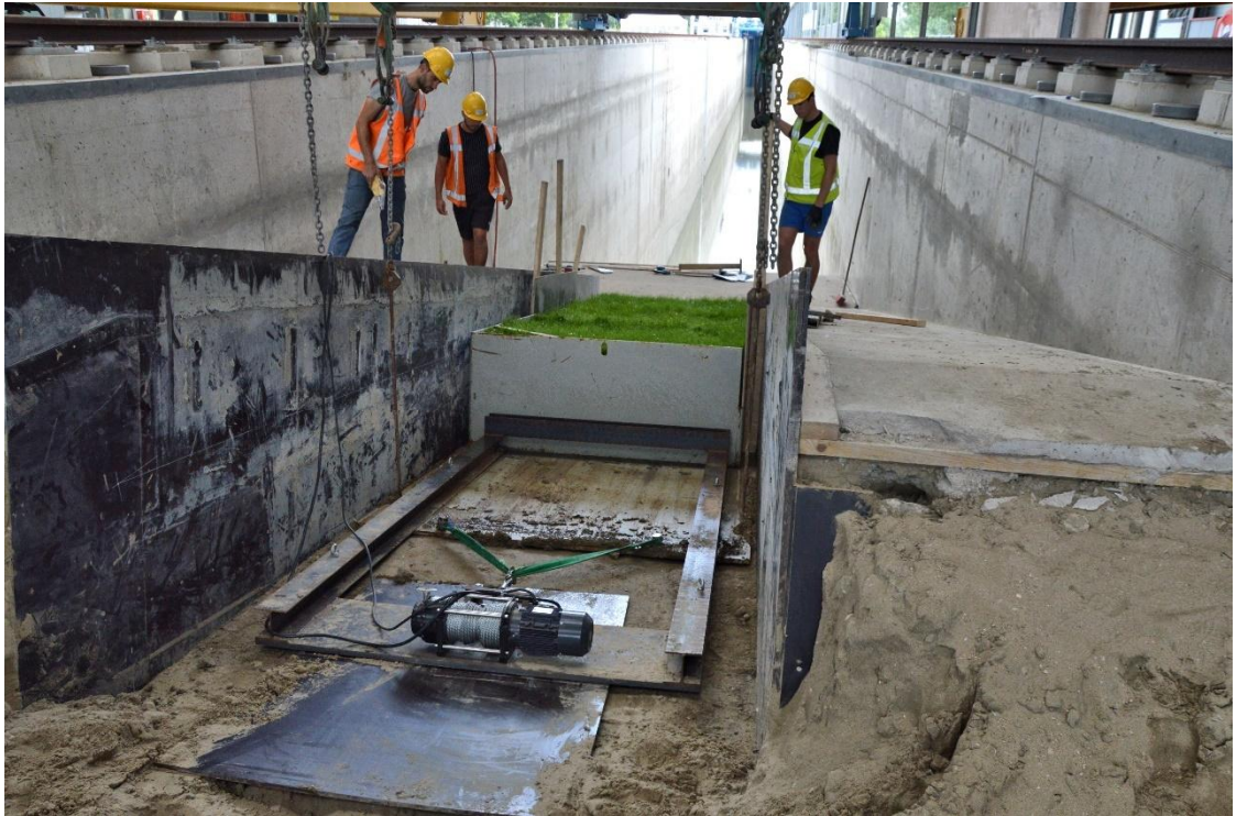
Fig. B-57 De bodemplaat onder het grasblok uittrekken
