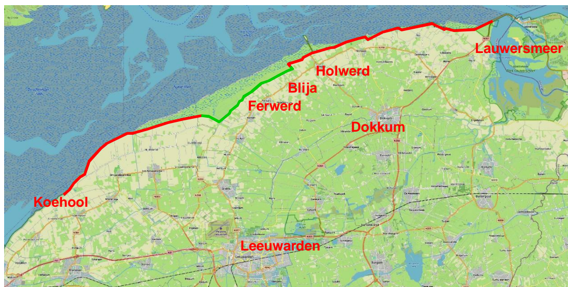
Figuur 1.3 De dijk Koehool-Lauwersmeer van het Wetterskip Fryslân (rood: met harde bekleding op het ondertalud; groen: volledig met kleibekleding en gras)
