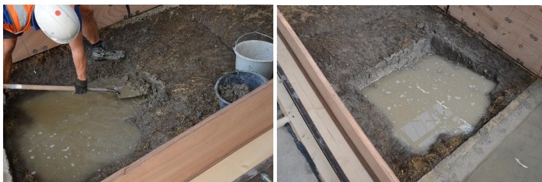
Figuur 5.11 Het aanbrengen van een kunstmatige klif voor proef K3_03
