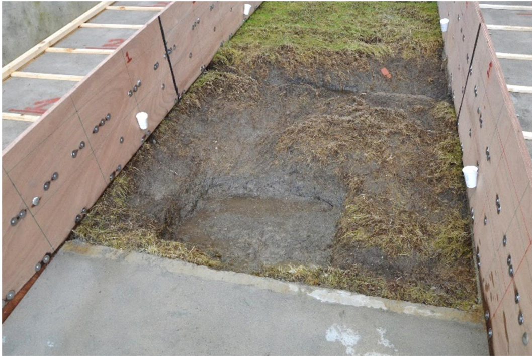
Figuur 5.8 Erosie aan het eind van de K2-serie waarmee gestart is in de K3 serie
