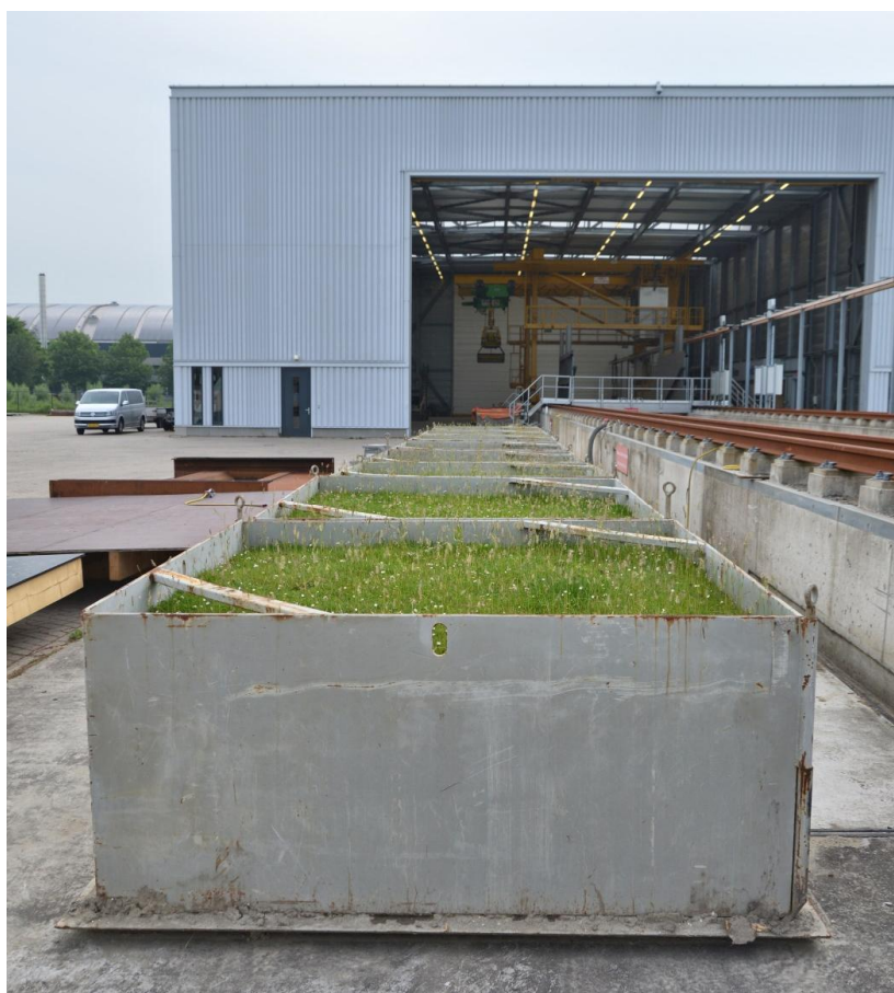
Figuur 2.4 blokken klei met gras in stalen mallen
