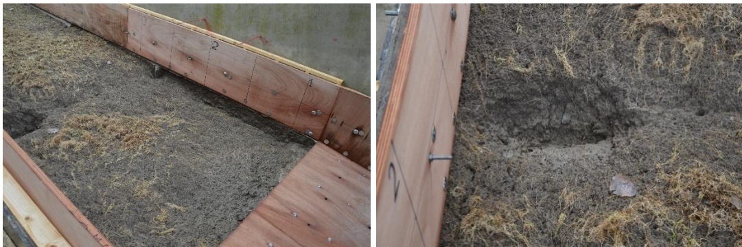
Figuur 6.14 Lokaal erosiegat na proef K2_06 ter plaatse van de aansluiting van het eerste en tweede kleiblok.
