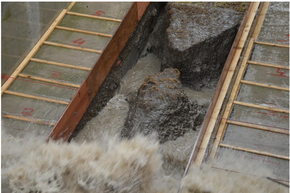
Fig. B-106 Tijdens proef K_13 breekt op een gegeven moment de kleirug in het midden door
