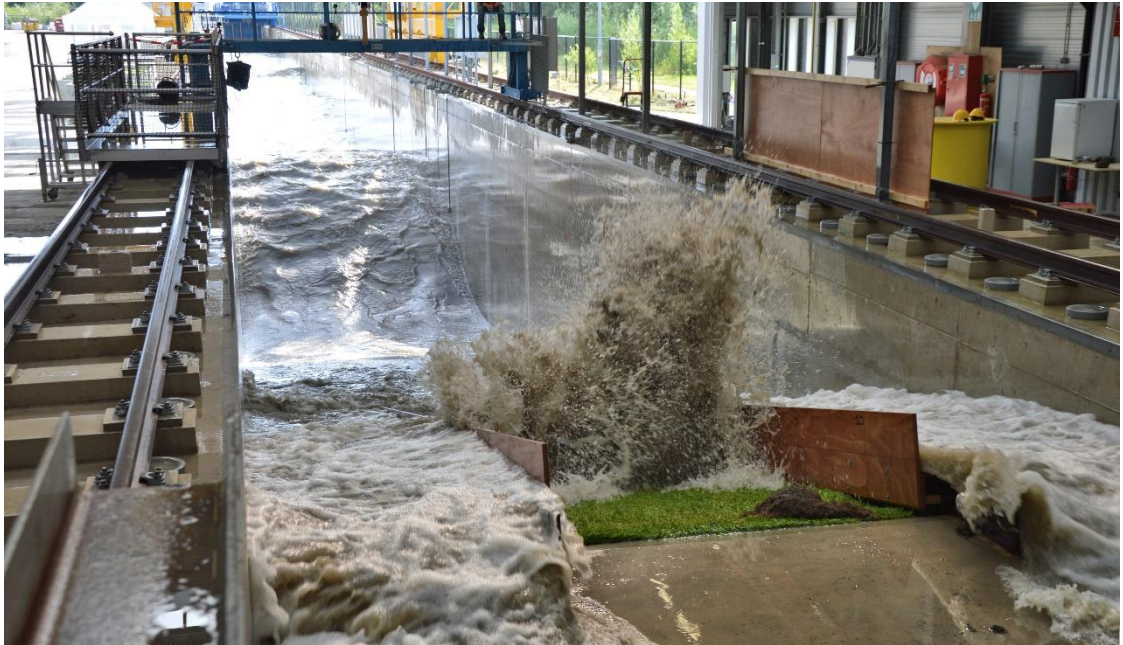
Fig. B-49 Tijdens golfoploop botst het water tegen de erosieklif en spat omhoog (proef K1_13)
