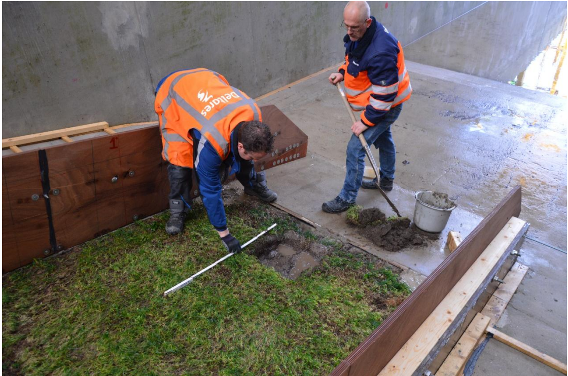
Fig. B-123 Vergroting van de kunstmatige schade (40 x 40 x 15 cm 3 )
