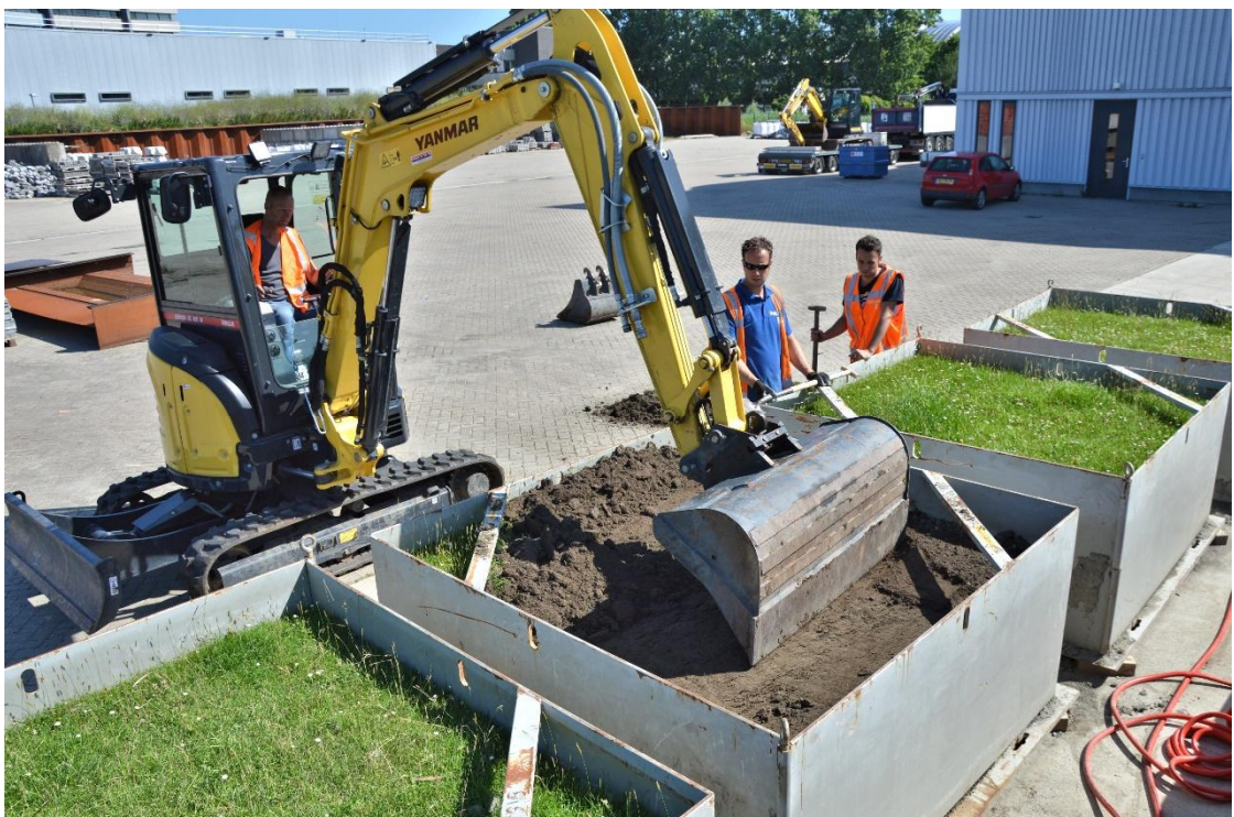
Fig. B-12 Gras verwijderen van de kleiblokken (bij twee kleiblokken was dit reeds op de Lauwersmeerdijk gedaan; bij de andere twee is dit naast de Deltagoot gedaan)
