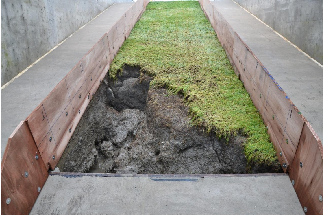
Fig. B-37 Erosiekuil na proef K1_08
