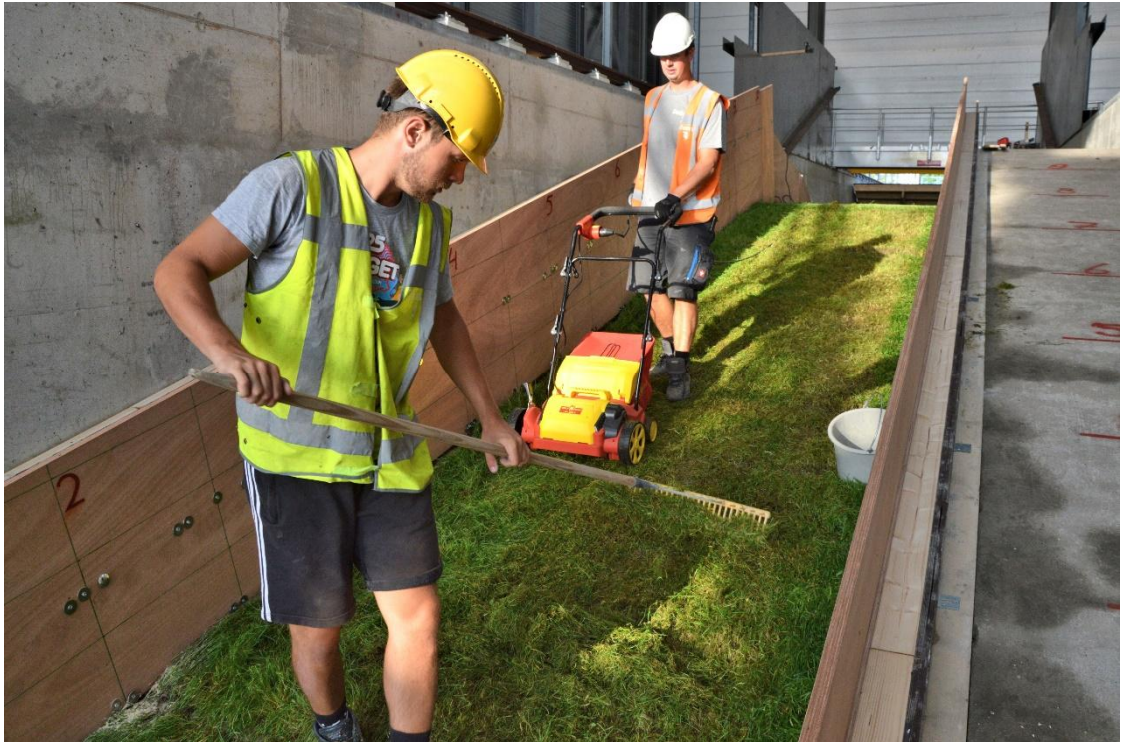
Fig. B-63 Verticureren van het gras ter verzwakking van de grasbekleding
