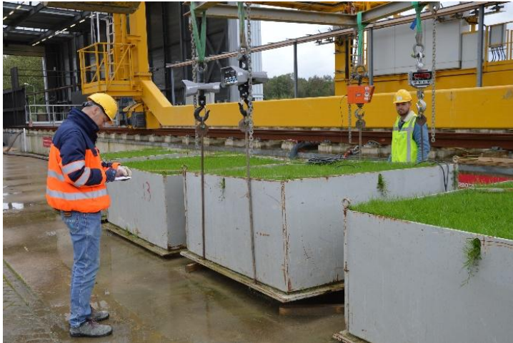
Figuur 3.6 De kleiblokken zijn regelmatig gewogen om het vochtgehalte te monitoren
