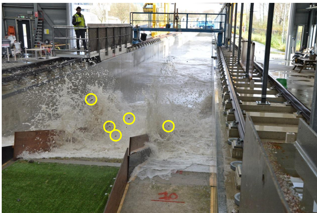
Figuur 6.15 Stukjes klei vliegen door de lucht tijdens golfaanval
