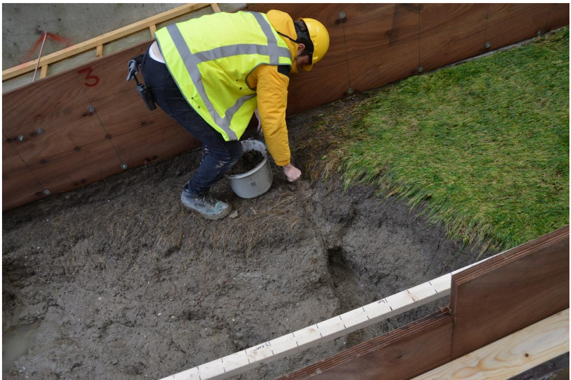
Fig. B-136 Tussen het tweede en derde kleiblok was een spleet aanwezig die de erosie sterk doet versnellen en die voor proef K6_05 deels is dicht gestopt
