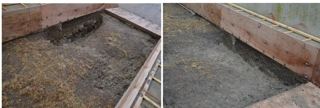
Figuur 5.13 Diep erosiegat dat plotseling ontstaan was tijdens proef K4_08 bij een relatief hoge waterstand (links) en de situatie na het deels opvullen van dit gat (rechts)
