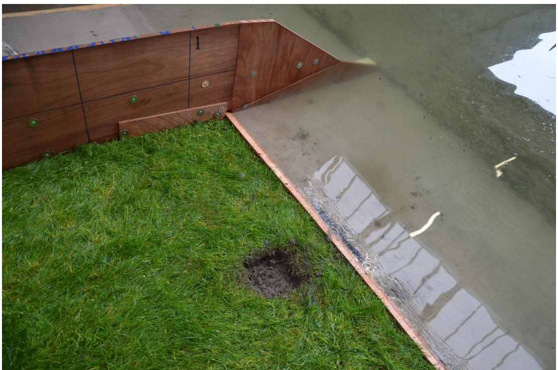
Fig. B-26 Kunstmatige schade vóór proef K1_04
