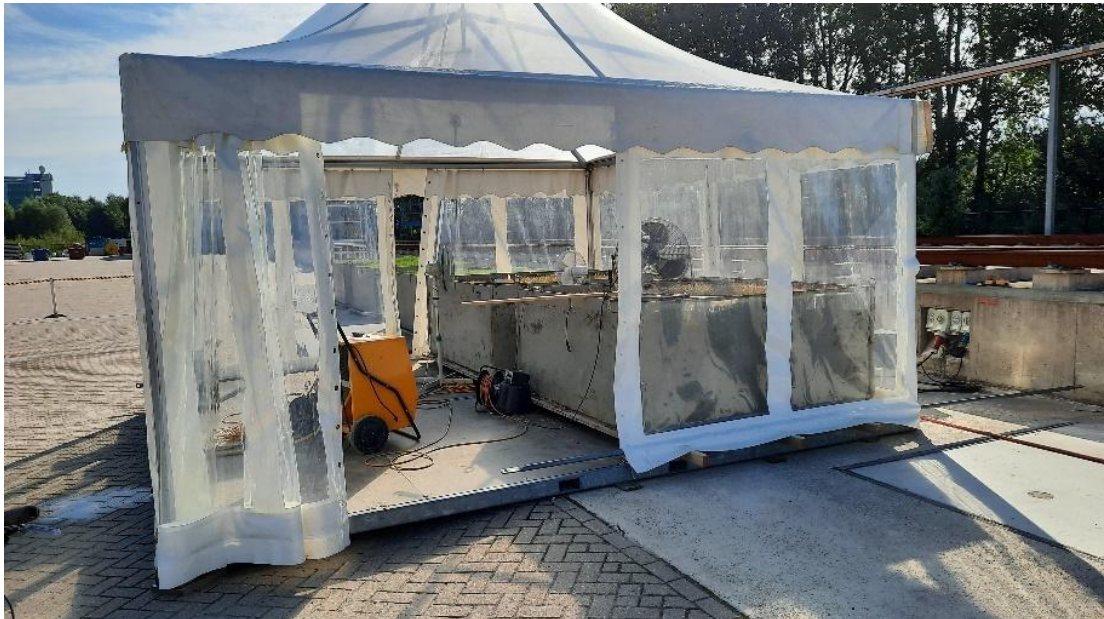
Figuur 4.18 Tent met twee kleiblokken met gras voor het simuleren van een hete droge zomer
