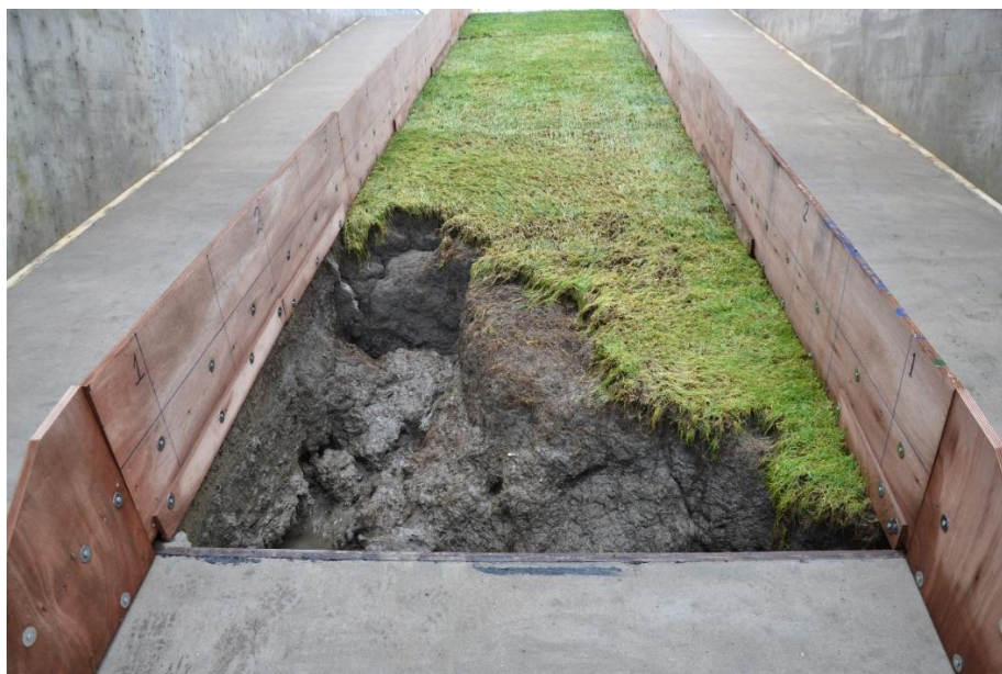
Figuur 5.9 Erosiekuil na proef K1_08
