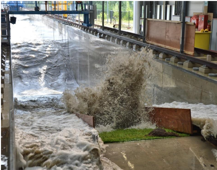
Figuur 5.10 Golf klappt tegen de klif, waarna het water omhoog spuit. Dit geeft een piekdruk tegen de klif die bepalend is voor de erosiesnelheid
