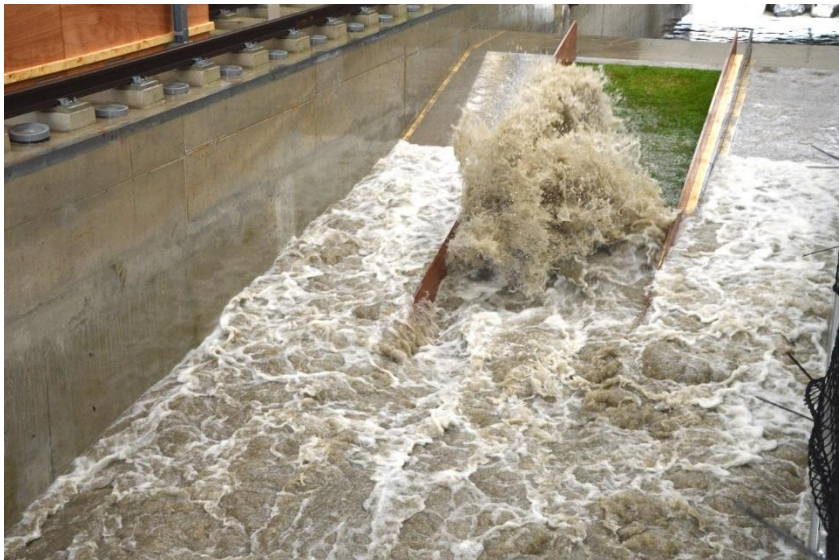
Figuur 4.5 Tijdens golfploop botst het water tegen de erosieklif en spat omhoog (proef K1_11)
