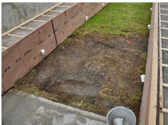
Figuur 3.11 Erosie van de kleibekleding met gras voor aanvang van proef K3-01
