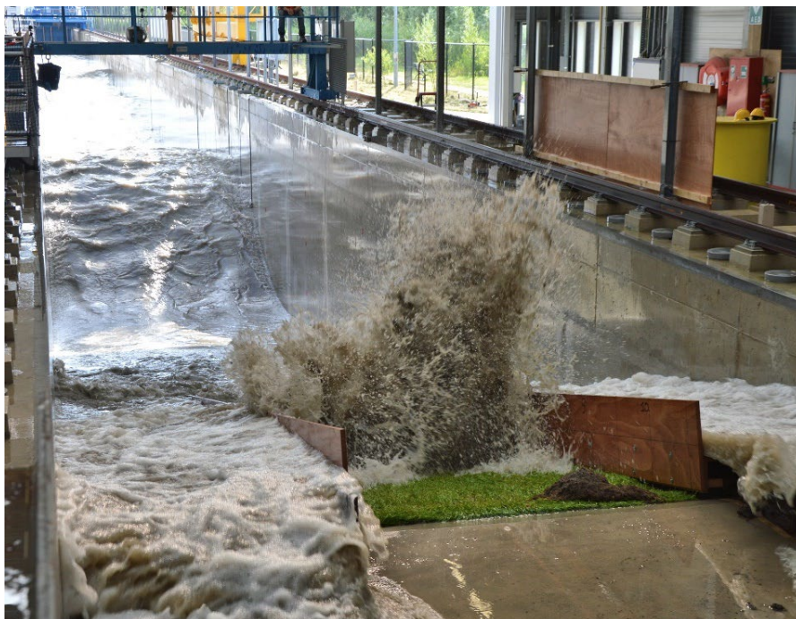
Figuur 5.10 Golf klapt tegen de klif, waarna het water omhoog spuit. Dit geeft een piekdruk tegen de klif die bepalend is voor de erosiesnelheid
