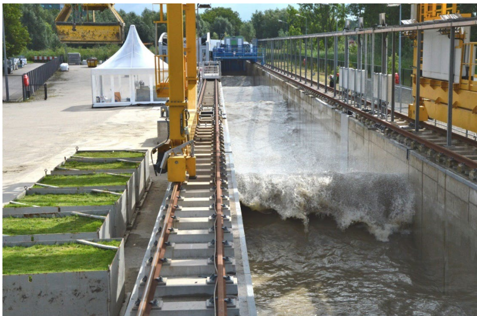
Figuur 1.4 Deltagoot van Deltares met naast de goot kleiblokken met gras in stalen mallen en een tent met twee kleiblokken met gras die een kunstmatige hete en droge zomer doormaken (zie hoofdstuk 3)
