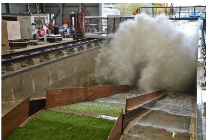
Figuur 8.1 Golfbelasting in de Deltagoot op een dijk met profiel van de Lauwersmeerdijk
