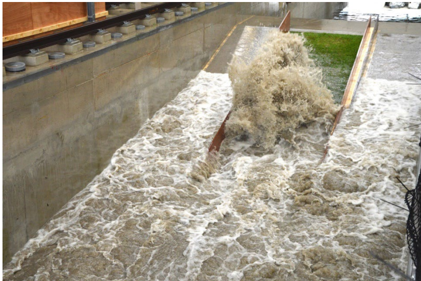
Figuur 4.5 Tijdens golfoploop botst het water tegen de erosieklif en spat omhoog (proef K1_11)
