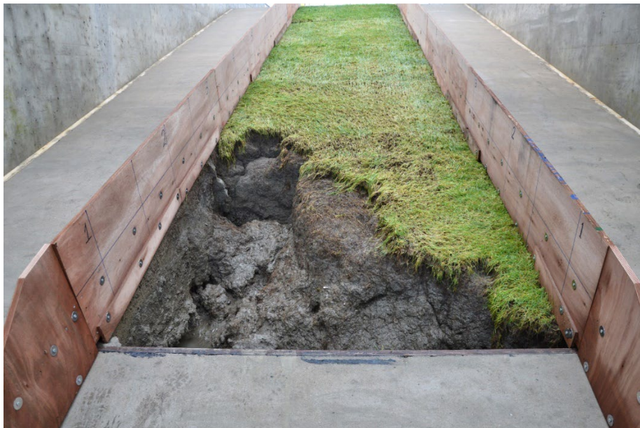
Figuur 5.9 Erosiekuil na proef K1_08
