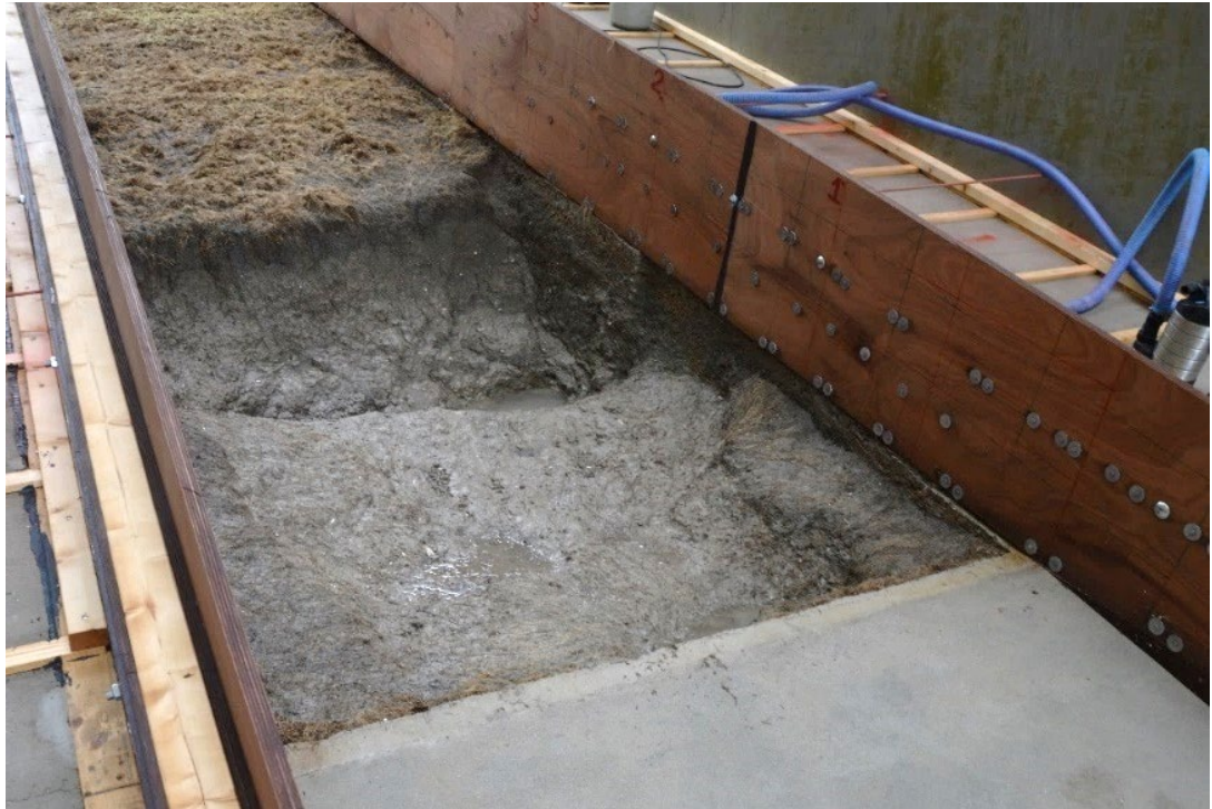
Figuur 3.12 Vanaf proef K3_06 is er een duidelijke klif in het tweede kleiblok.
