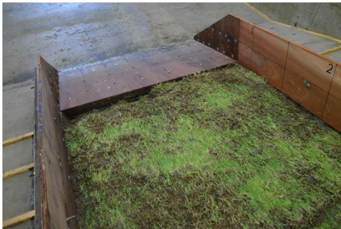
Figuur 3.16 Erosie bij de overgang na proef K4_01
