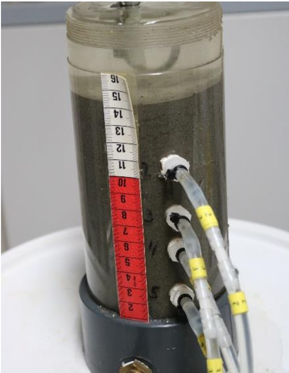
Figuur B-17 Gebruikte opstelling voor het meten van de doorlatendheid
