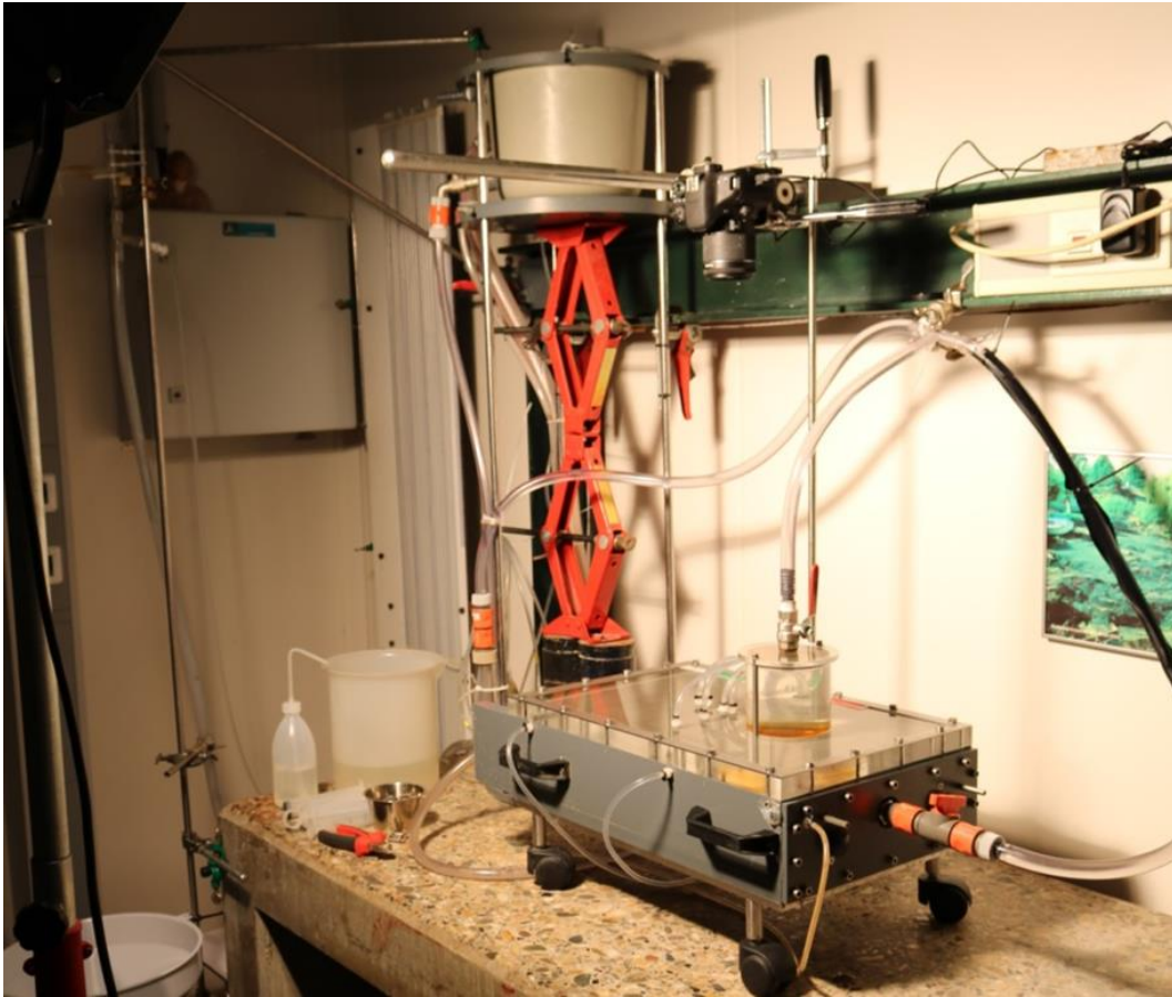
Figuur 7-2 Opzet van kleine schaalproef. Het water in de grijze emmer zorgt voor druk via een slang die aan het bakje verbonden is. Door een communicerend vat aan de uitstroomkant van het bakje stapsgewijs te verlagen, wordt het verval vergroot.
