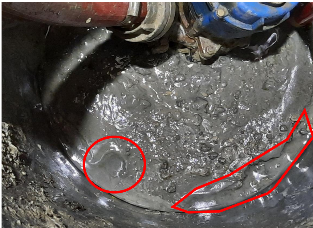
Figuur 5-2 Foto van de vier zandmeevoerende wellen die zijn aangegeven met de rode lijnen: 1 links en 3 in het rechtervlak.
