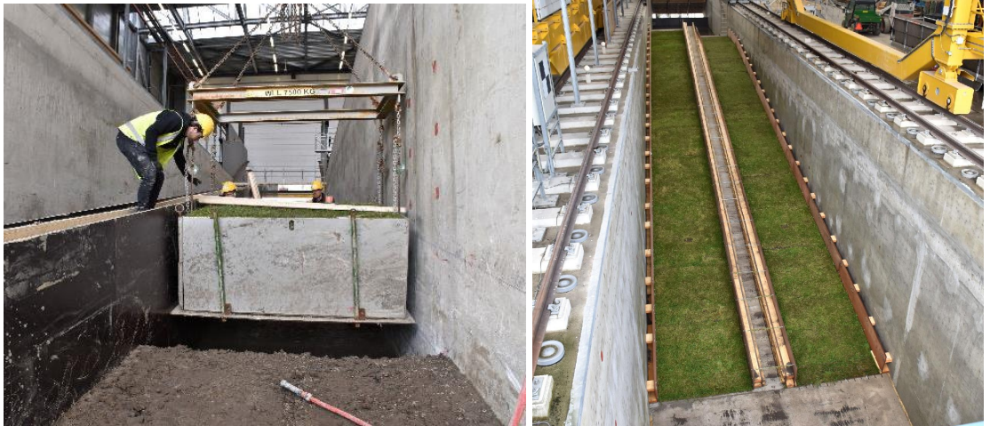
Figuur 8.4, In de Deltagoot worden de stalen bakken naast elkaar geplaatst (links) en wordt de grond met vegetatie uitgepakt en tegen elkaar geschoven, resulterend in een vrijwel naadloze kleilaag met vegetatie (rechts)
