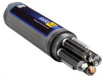
Figuur B.1. Sonde met meerdere sensoren voor het meten van o.a. watertemperatuur.
