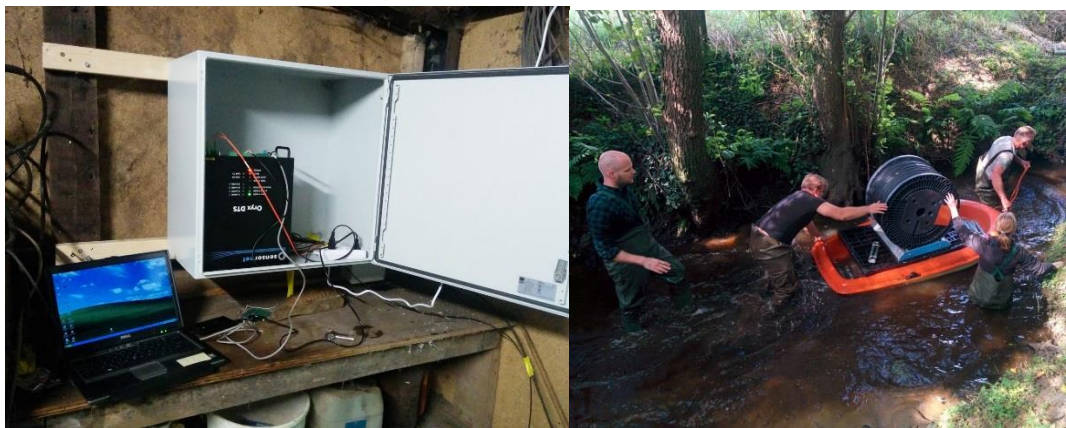
Figuur B.2. Meetkast (links) en aanbrengen van 1.5 km glasvezelkabel in een beek voor het continu meten van de watertemperatuur. Bron: Vince Kaandorp, Deltares.
