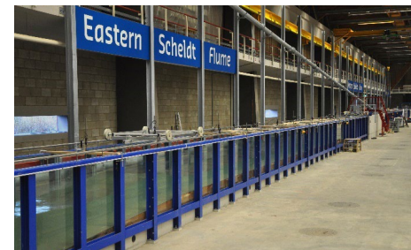
Deltares Scheldegoet waarin de golfoverslag is gesimuleerd
