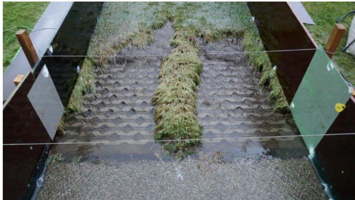
Beproefde overgang van asfaltbekleding naar doorgroeiestenen
