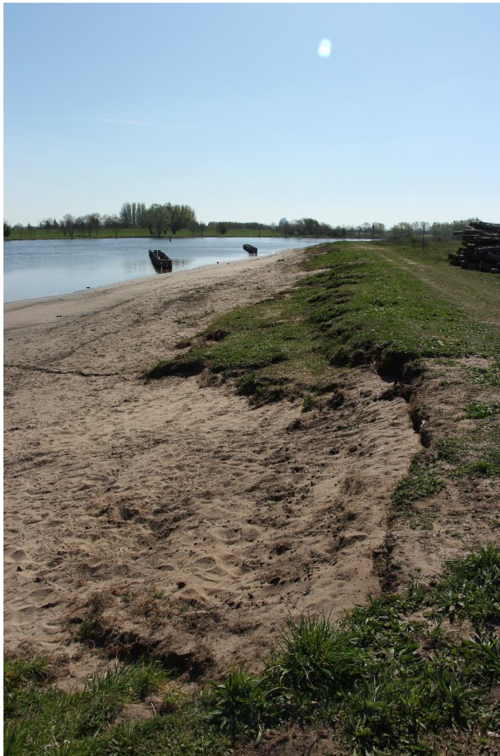
Figuur 5.5 Dubbele steilrand benedenstrooms van het derde scherm.
