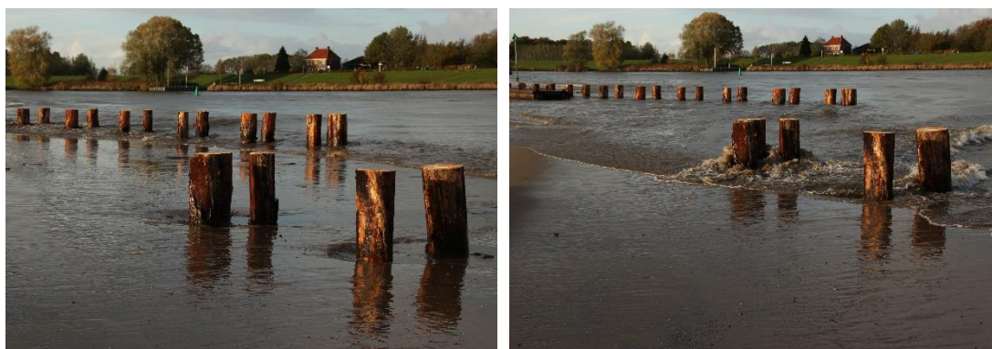
Figuur F.1 Stroombeeld rond de staanders bij passage van een schip (4388, 4389).
