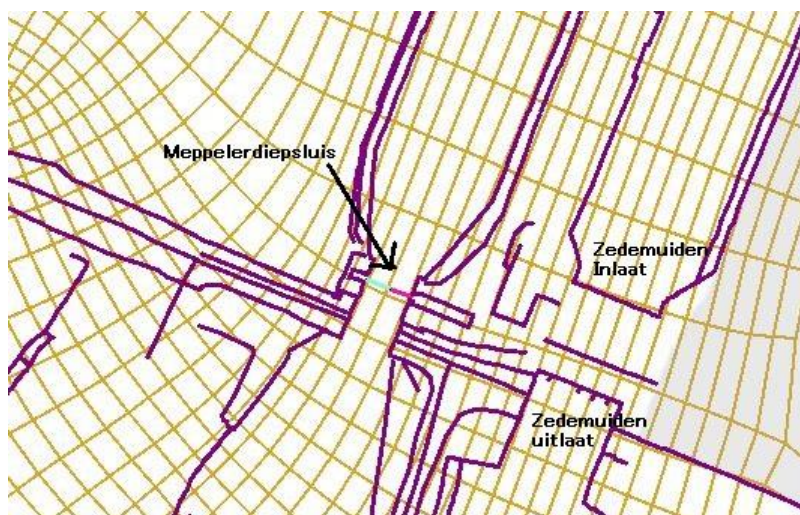
Figuur 7.1 De ligging van de Meppelerdiepsluis en pomp Zedemuden. De lichtgroene en roze lijn geven aan waar respectievelijk de pomp en de sluis zijn opgenomen. Tussen de locaties van de werkelijke in- en uitlaat van Zedemuden liggen meerdere roostercellen, waardoor de pomp hier niet kan worden opgenomen.
