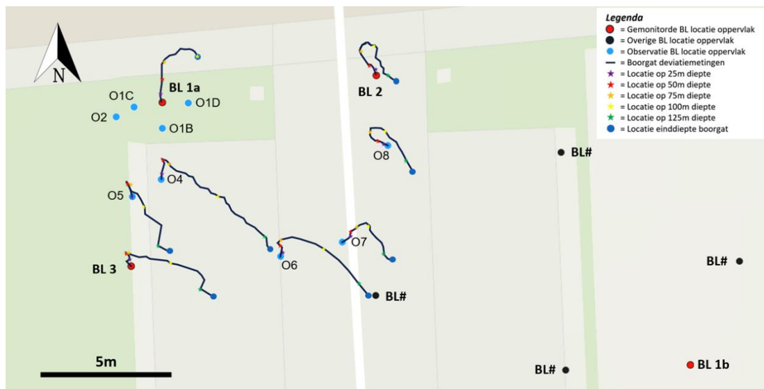
Figuur 3-2 Overzicht van de bodemzijdige monitoringspunten. BL (rood) betreft een u-lus van een bodemwarmtewisselaar die gemonitord wordt, O (blauw) is een monitoringspunt tussen of rond de bodemwarmtewisselaars. BL# geeft de locatie van een bodemwarmtewisselaar aan die niet gemonitord wordt. De genoemde punten geven de locatie aan maaiveld. BL2 en BL3 zijn 132 m diep; BL1a en BL1b zijn parallel geschakeld (gekoppeld aan één appartement) en beide 102 m diep. Met zwarte lijnen is het verloop van de boringen aangegeven met de diepte zoals die is vastgesteld op basis van deviatie metingen in de betreffende boorgaten.
