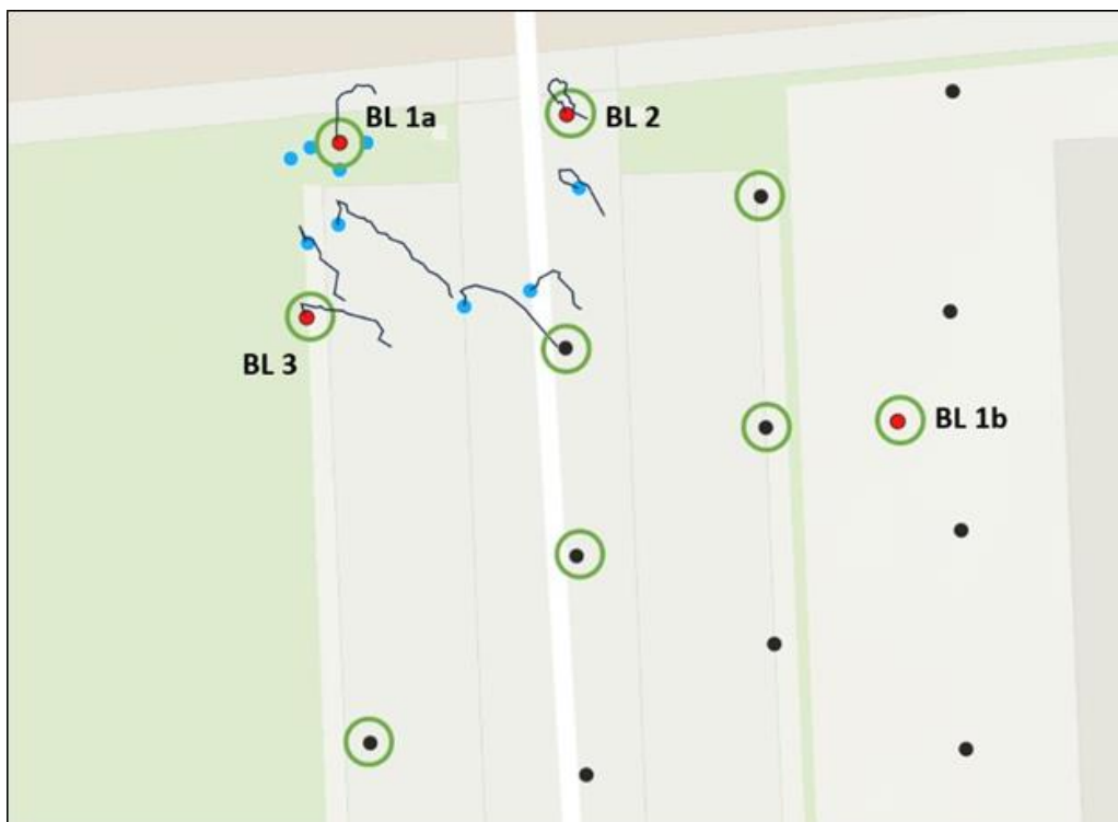
Figuur K-5. Bovenaanzicht met oppervlaktelocaties gemonitorde bodemwarmtewisselaars (rode stippen), niet gemonitorde bodemwarmtewisselaars (zwarte stippen), en observatieboorgaten (blauwe stippen). De zwarte lijnen geven een indicatie van het 3D verloop van de boortrajecten van de boorgaten waar deviatiemetingen zijn uitgevoerd. In de initiële Feflow modellen waren alleen de gemonitorde bodemwarmtewisselaars 'actief'. De groene cirkels geven aan welke bodemwarmtewisselaars 'actief' zijn gemaakt tijdens de extra simulatie voor model 1
