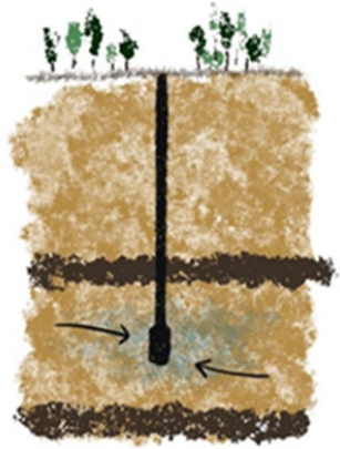
Figuur 3.2: Diepe grondwaterwinning vanuit voorraad afgesloten van boven- en onderliggende lagen door ondoorlatende lagen.
