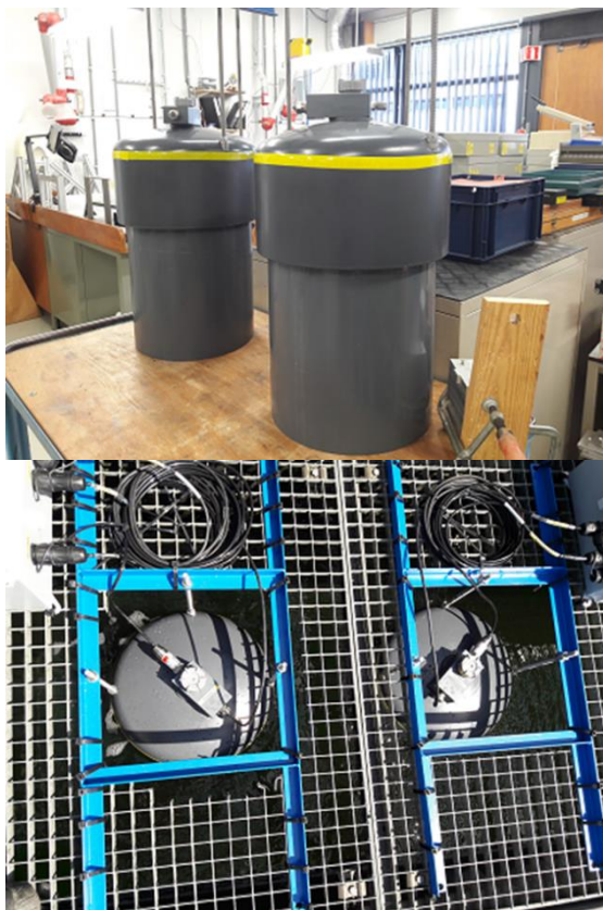
Figuur 14 Gasklokmetingen voor het vaststellen van de gasemissie naar de atmosfeer, IJsselooog, 2018
