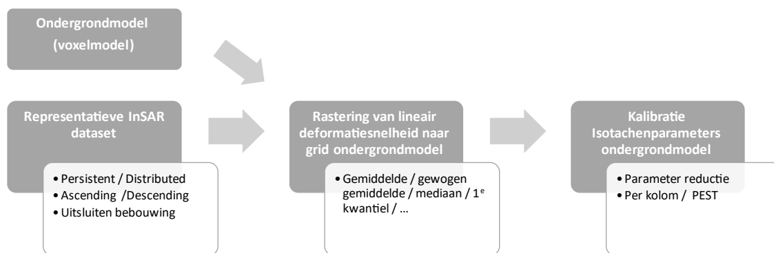
Figuur 4 Stappen in de parametrisatie op hoofdlijnen. Kalibratie wordt veelal gedaan met PEST , een softwarepakket voor model-onafhankelijke parameter schatting en onzekerheidsanalyse.
