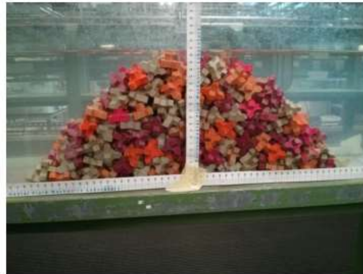
Figuur 5 – Proefopstelling stabiliteit test stroomgoot zijaanzicht. Links: helling 1:1,5, Rechts: helling 1:1.
