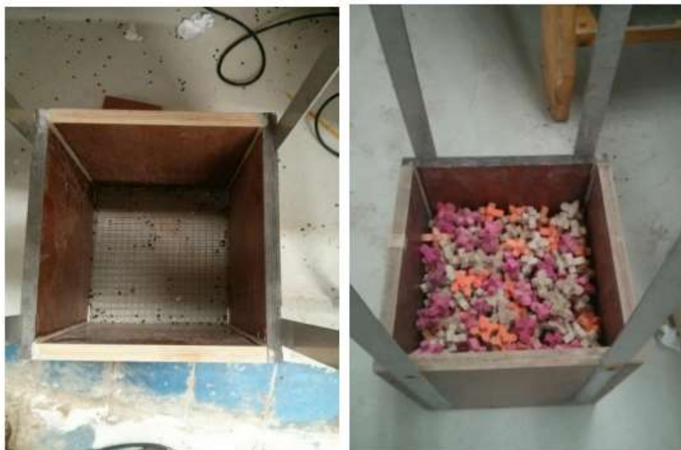
Figuur 1 – Links: houten bak met gaas op de bodem waardoor water kan stromen. Rechts: bak gevuld met model Xstreams
