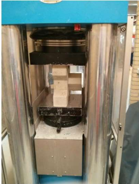
Figuur 31- Proefopstelling druktest Xstream
