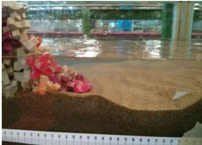
Figuur 13 – Links: bovenaanzicht na t=59 minuten, rechts: Benedenstroomse zijde van de krib aan de voorzijde na t= 59 minuten
