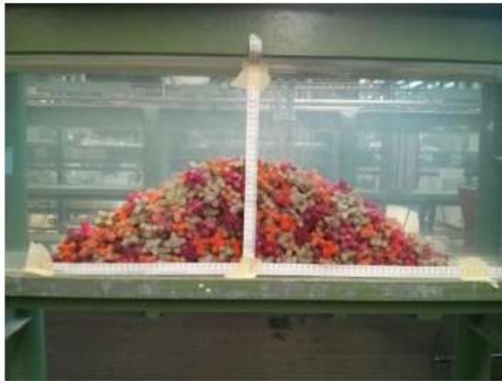
Figuur 5 – Proefopstelling stabiliteit test stroomgoot zijaanzicht. Links: helling 1:1,5, Rechts: helling 1:1.
