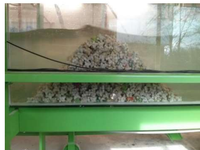
Figuur 25 – Proefopstelling Kruin en waterstand gelijk
