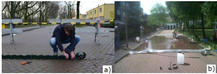
Figuur 5: Tests op volledige schaal van waterpasserende verharding in Utrecht (bron: Boogaard & Lucke, 2019).
