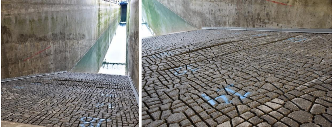
Figuur 4.4 Vervorming van de steenzetting na proef RXL-12 (zie ook Fig. B-7 links)
