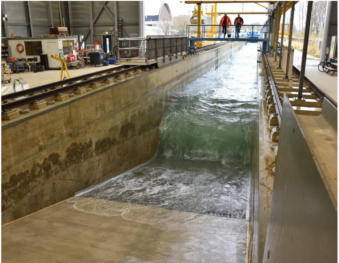
Fig. E-10, golfbelasting tijdens proef RXL-03
