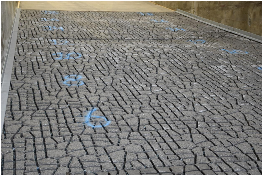
Fig. E-19, Vervorming na proef RXL-12
