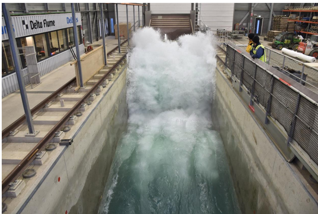
Figuur 6.1, Golfbelasting tijdens proef RXL-08
