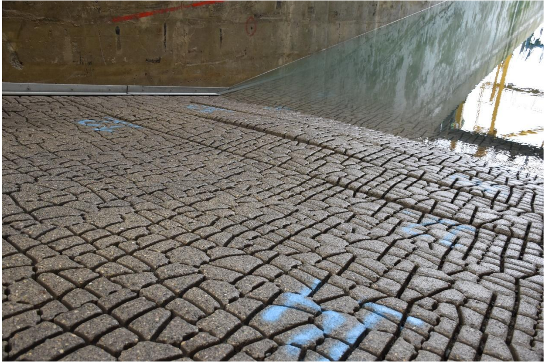
Fig. E-18, Vervorming na proef RXL-12
