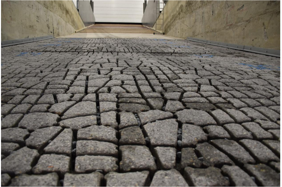
Fig. E-16, Vervorming na proef RXL-11
