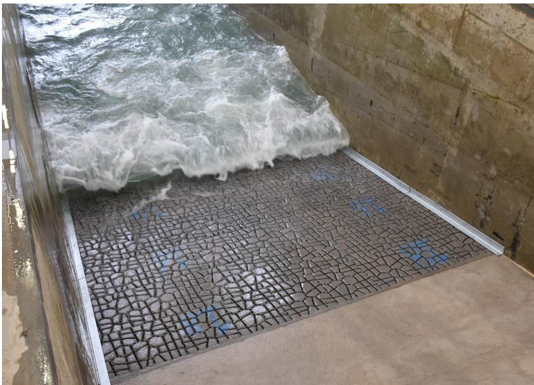
Figuur 4.1 Golfbelasting op talud met RONA®ton XL tijdens ingolfproef (proef RXL-01)
