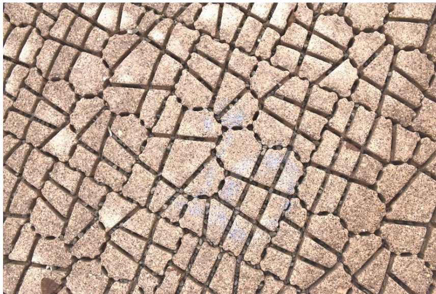
Figuur 4.6 Indruk van het resterende Inwasmateriaal na proef RXL-10 in rij 10
