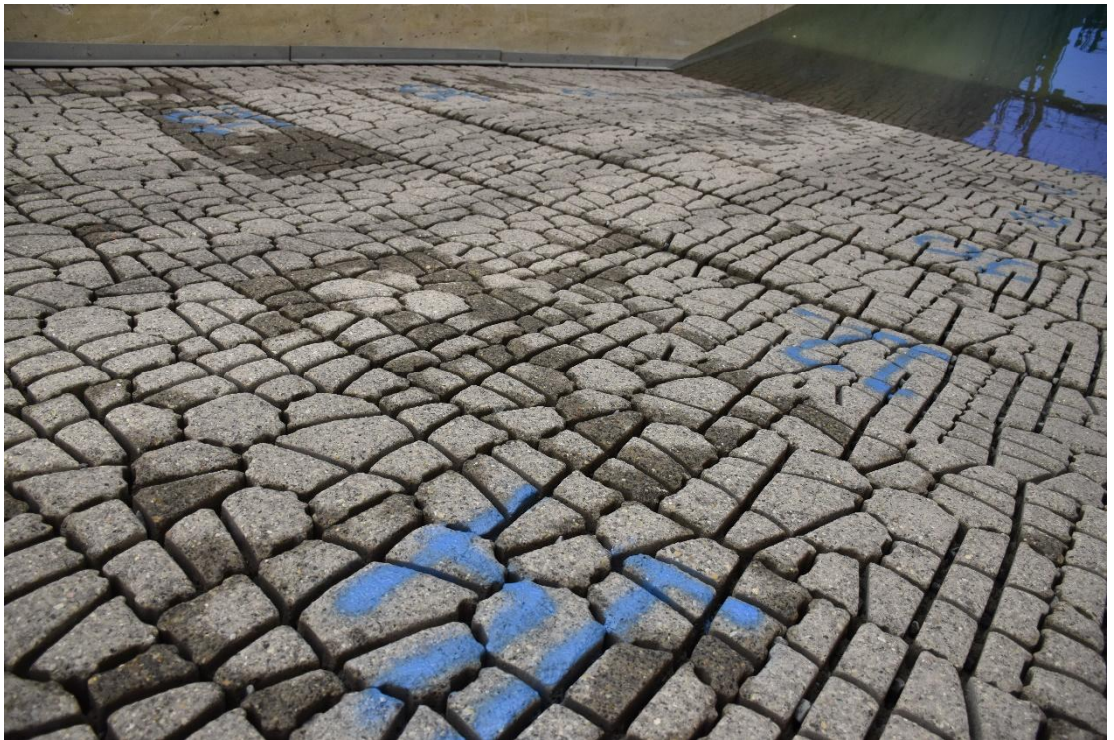
Fig. E-15, Vervorming na proef RXL-11
