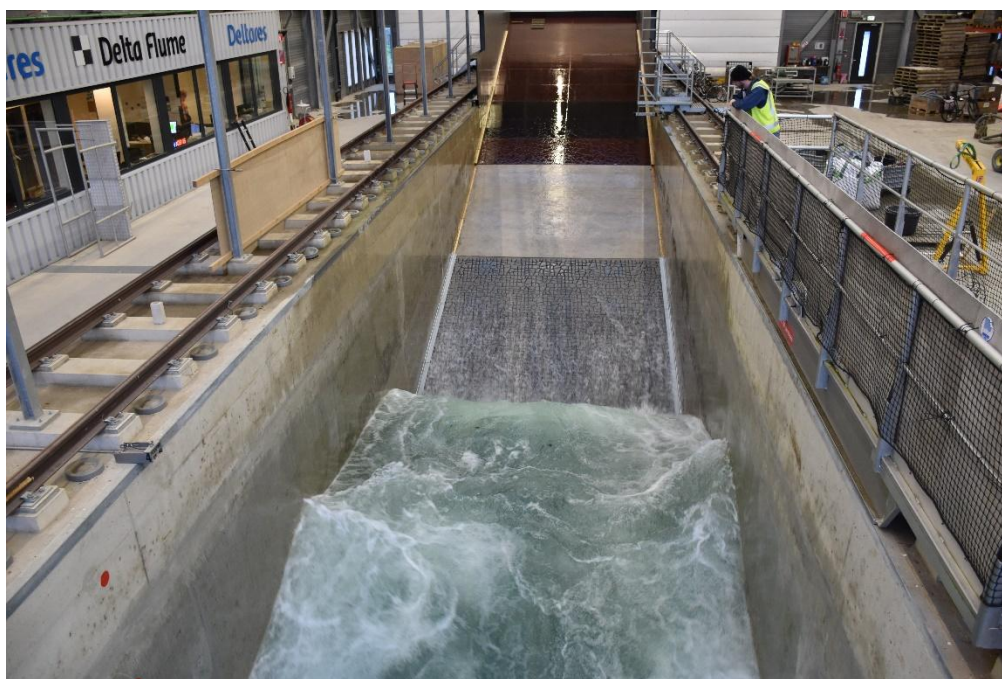
Figuur C.1.1 Golfaanval op testsectie van RONA®ton XL
