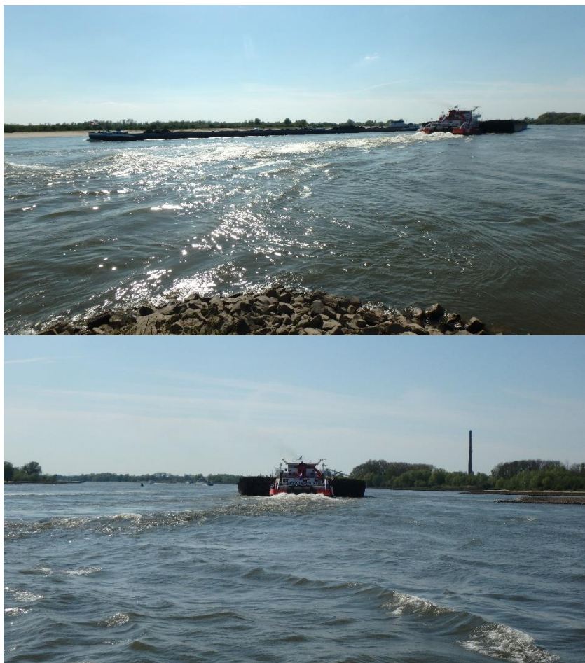
Figuur 3-7 Strooming en golven achter de Veerhaven XI - IJsbeer (ongeladen 6-baks duwstel, dalvaart) op de Waal ter hoogte van km 878 (Foto's Kees Sloff, 2022)
