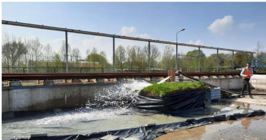
Figuur 1.3 Impressie van de tweede oriënterende testen op grasblok 'Blija' (overgenomen uit Deltares, 2021b).
