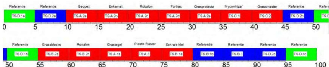
Figuur 2.2 Schematisatie van testsecties overgenomen van Deltares (2016).
