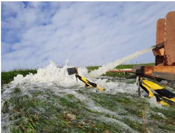
Figuur 2.12 Aangebrachte belasting bij stroomsnelheid van 7,5 m/s en een hoek van spuitmond van \alpha_s = 20^\circ .
