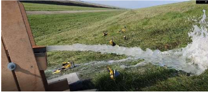
Figuur 2.13 Aangebrachte belasting bij stroomsnelheid van 4,5 m/s en een hoek van spuitmond van \alpha_s = 10^\circ .
