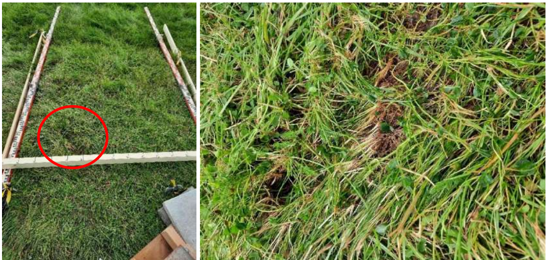
Figuur 0.2 Schade bij meting 1 proef 1a.
